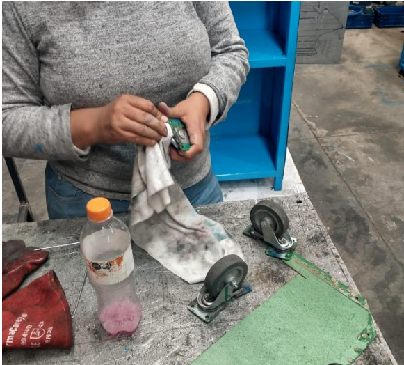
Ilustración 33.- Limpieza de llantas para ser colocadas en el termorregulador
