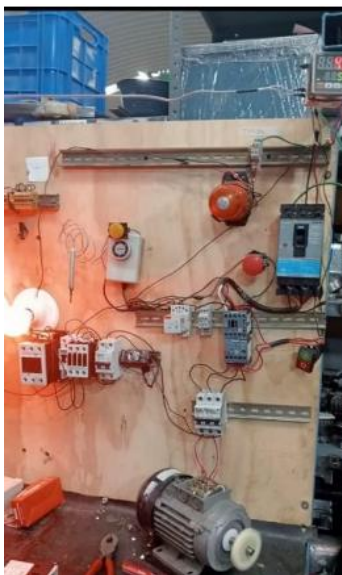
FIGURA 18.- EMULACION FÍSICA DE LOS COMPONENTES ELÉCTRICOS
