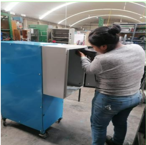
Ilustración 34.- Instalación del gabinete eléctrico a la estructura
