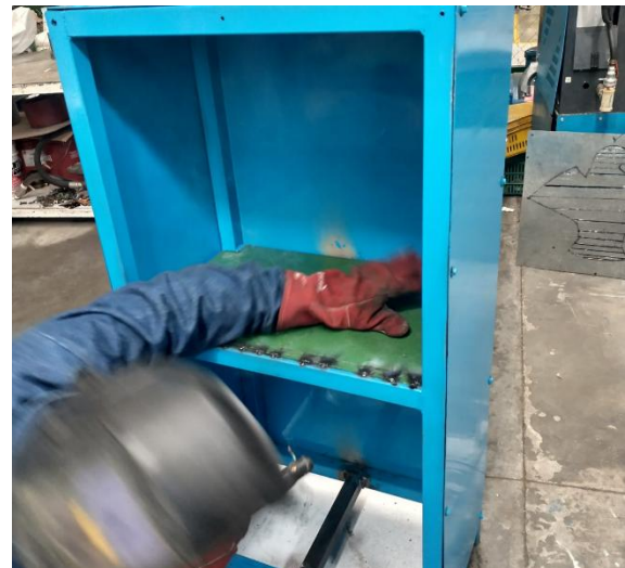
Ilustración 31.- Colocación de soportes internos y pintado de la estructura
