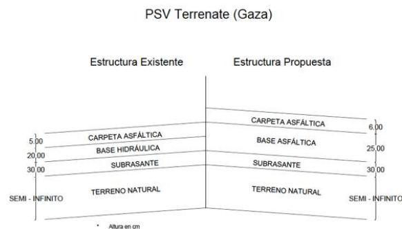
Ilustración 19. Propuesta de Estructura de Pavimento - Terrenate
