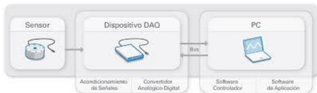
Figura 4. “Esquema básico de un sistema de adquisición de datos”
