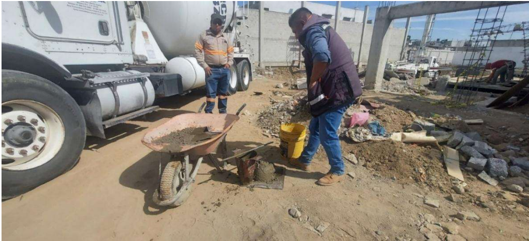
Figura 132. Prueba de revenimiento para alberca
