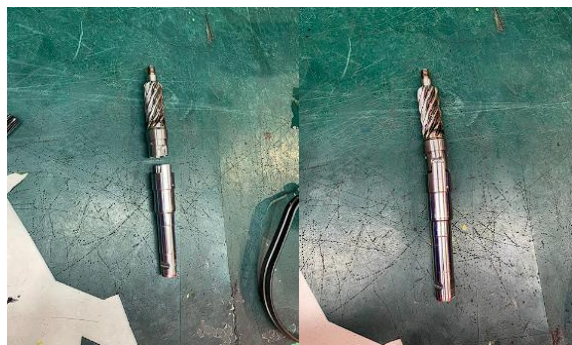
Ilustración 23 Posición de ensamblaje de shaft y pinion.
