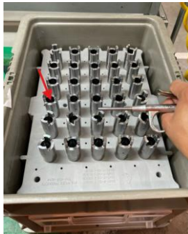
Ilustración 14 Limpiezas de los diámetros internos de los componentes.
