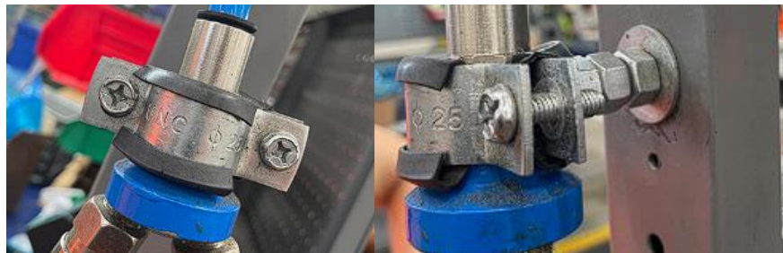
Ilustración 33 Abrazaderas omega y uña para fijación de tubería.
