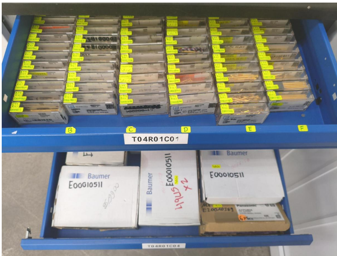
Ilustración 42 Refacciones acomodadas de acuerdo con su ubicación asignada en SAP para una búsqueda más dinámica y eficiente
