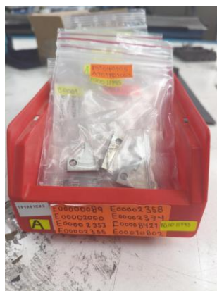
Ilustración 41 Muestra de uno de los contenedores del locker principal con sus indicadores visuales (número asignado dentro del locker, número de refacciones que contiene), además de un ejemplo de una bolsa con refacciones con sus indicadores visuales)
