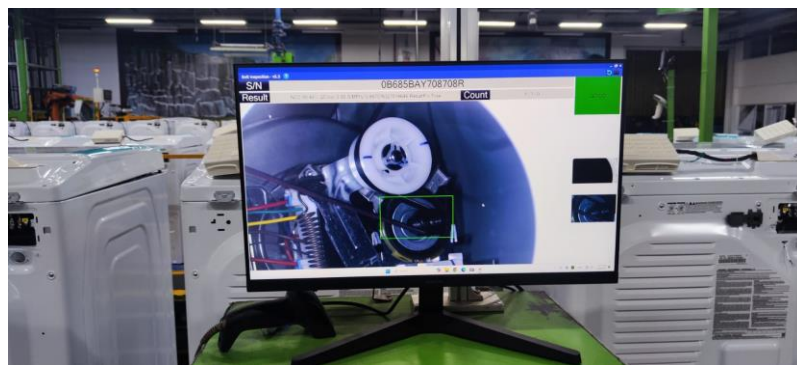
Figura 2.6 Interfaz gráfica de Belt Inspection en SEM -P
