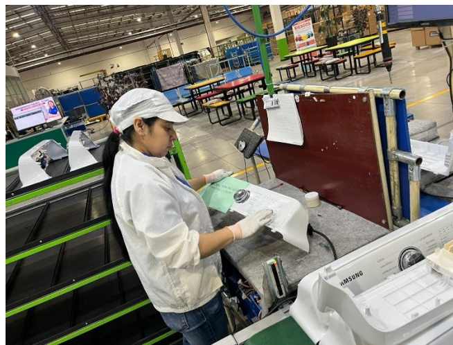
Figura 2.2 Inspección de calidad de panel control de lavadora
