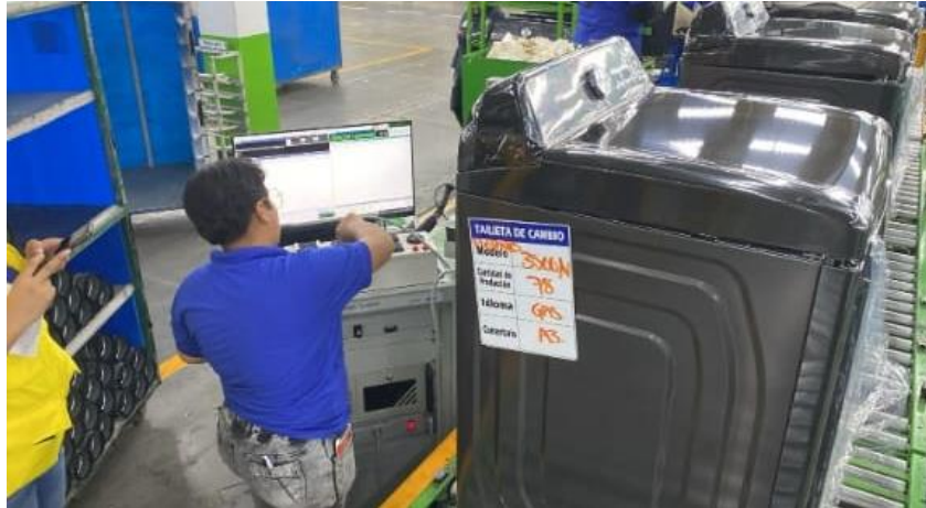
Figura 3.13 Prueba de interfaz con el primer ser de un lote de lavadoras
