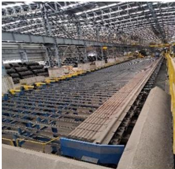
Ilustración 12: Cama de enfriamiento de Simec International P2
