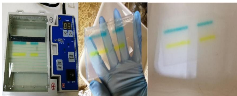
Figura 23. Cámara electroforética y geles de agarosa con corrimiento de DNA a 90 V
