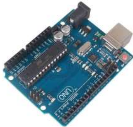
Figura 9. Arduino UNO R3: microcontrolador ATmega328 (fuente: electrocrea.com).
