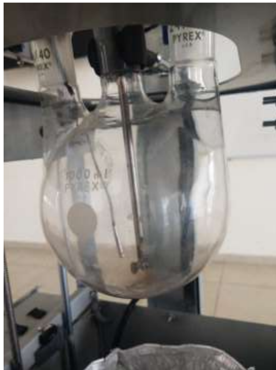
Figura 61. Acercamiento interior de reactor: agitador y sensor
