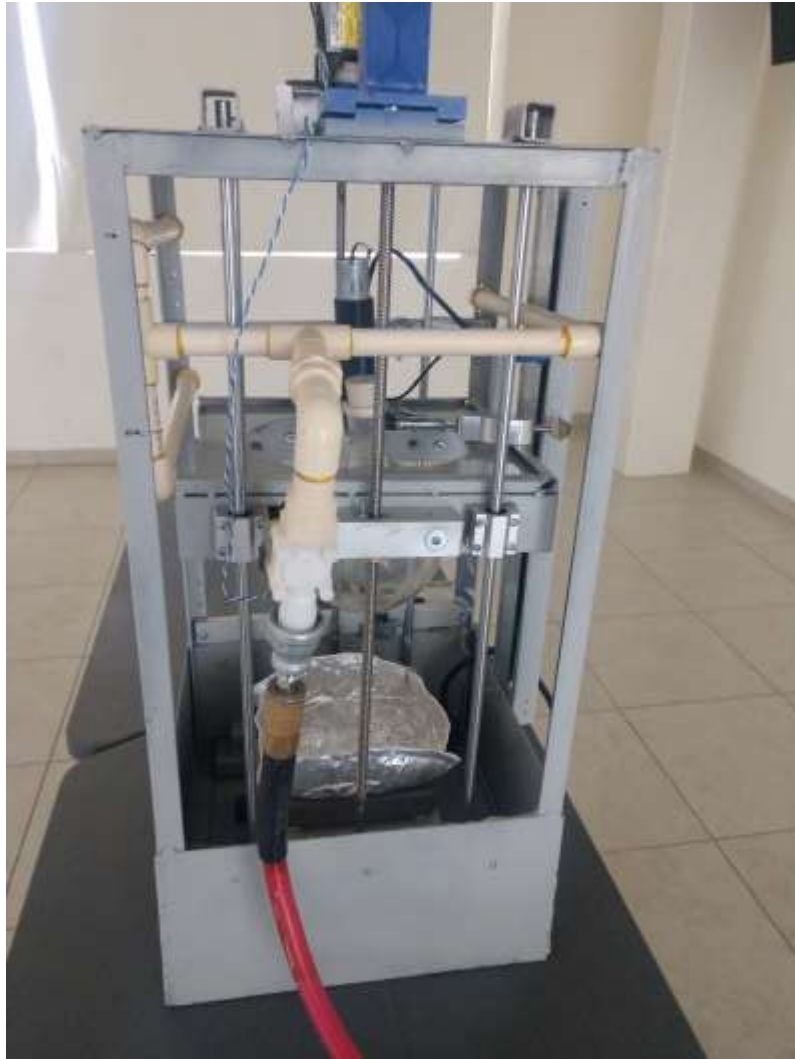
Figura 55. Vista lateral sistema de módulos completos: se observa la válvula del sistema de enfriamiento y ductos tipo aspersor.
