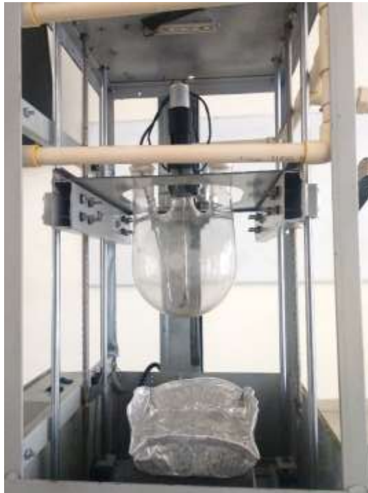
Figura 63. Parte inferior de la placa porta-reactor.
