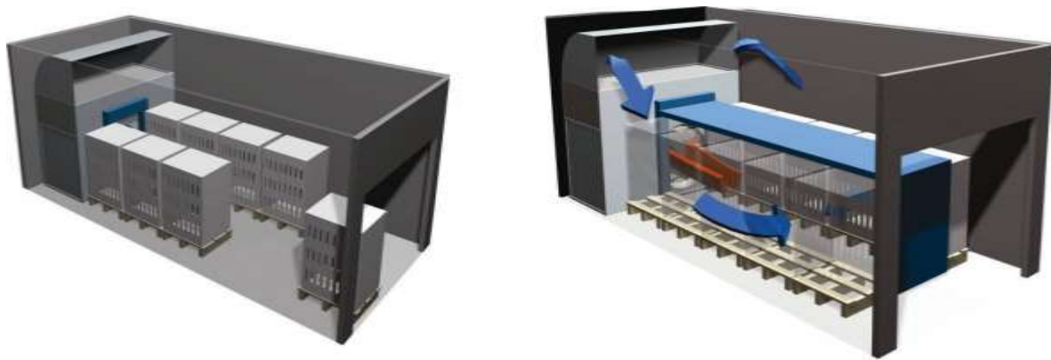
Figura 7. Túneles de pre enfriamiento por aire forzado (fuente: mundohvacr.com.mx).
