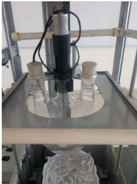
Figura 67. Parte superior de la placa porta-reactor.
