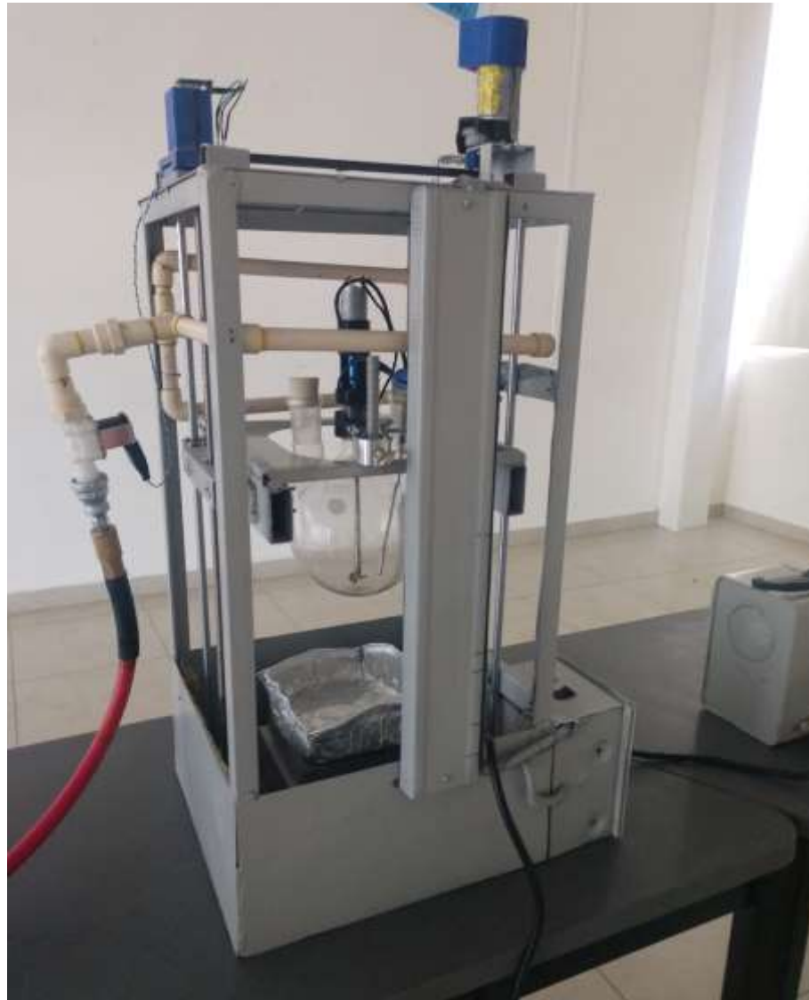
Figura 54. Vista posterior sistema de módulos completos: se observa la válvula de enfriamiento, torre de soporte principal, reactor, baño maría, sistema agitación del reactor.
