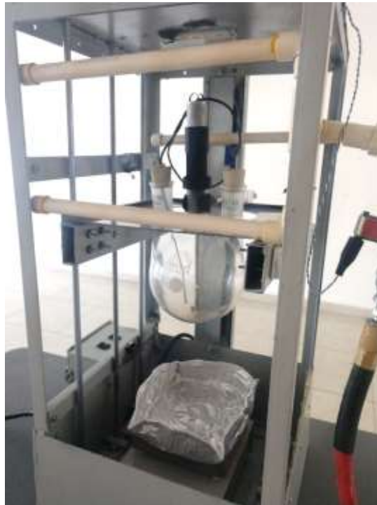
Figura 57. Acercamiento 1 interior de zonas caliente y fría y de reactor.
