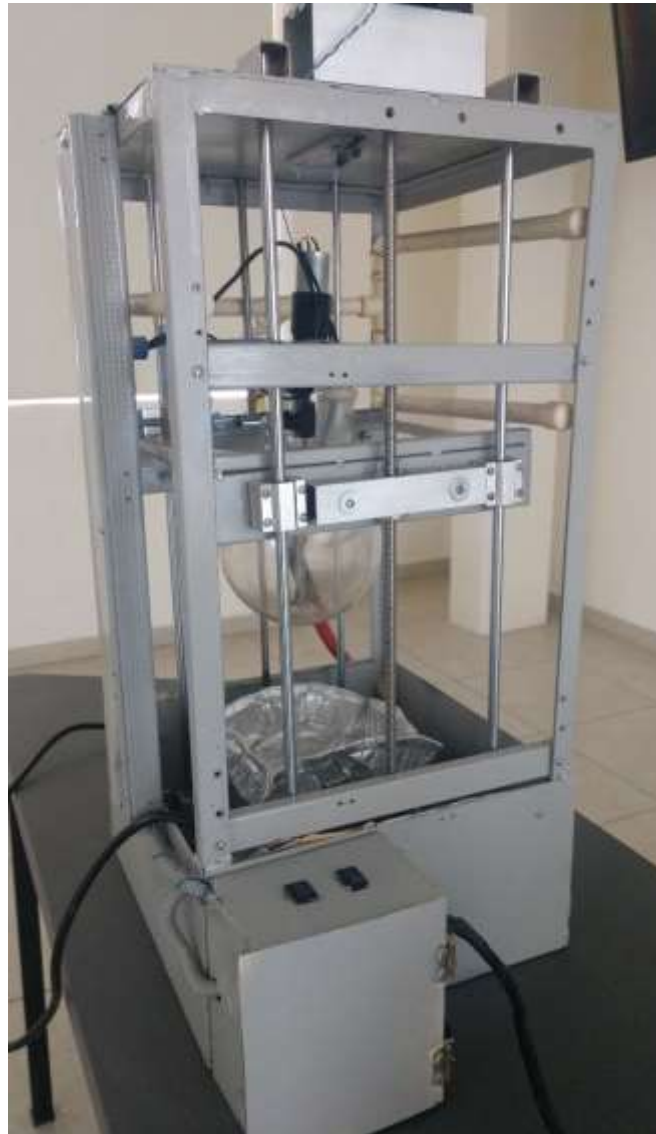
Figura 56. Vista lateral sistema de módulos completos: se observa gabinete de caja de poder, estructura de soporte y reactor en suspensión.
