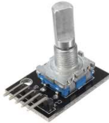
Figura 11. Potenciómetro KY-040 Encoder Rotatorio (fuente: electrocrea.com).
