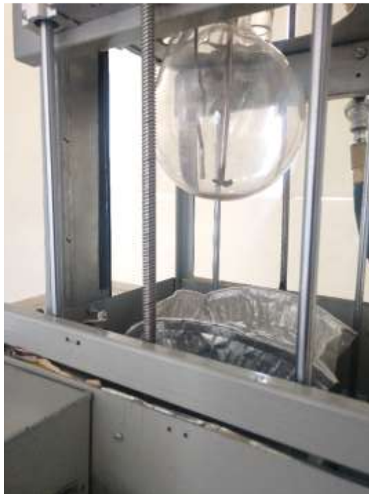
Figura 60. Acercamiento parte inferior de reactor: agitador y sensor.
