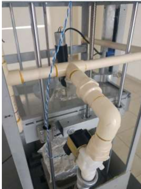
Figura 69. Ductos de entrada sistema de enfriamiento.
