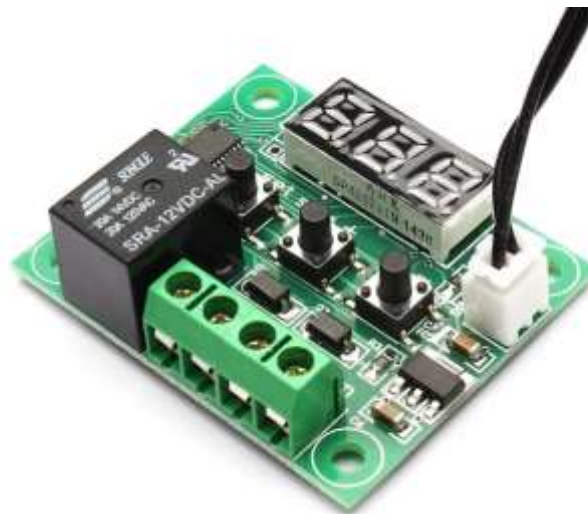
Figura 5. Termostato W1209 (fuente: arduinove.com).
