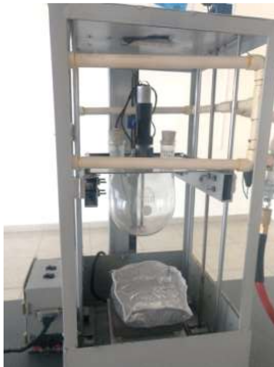
Figura 58. Acercamiento 2 interior de zonas caliente y fría y de reactor.
