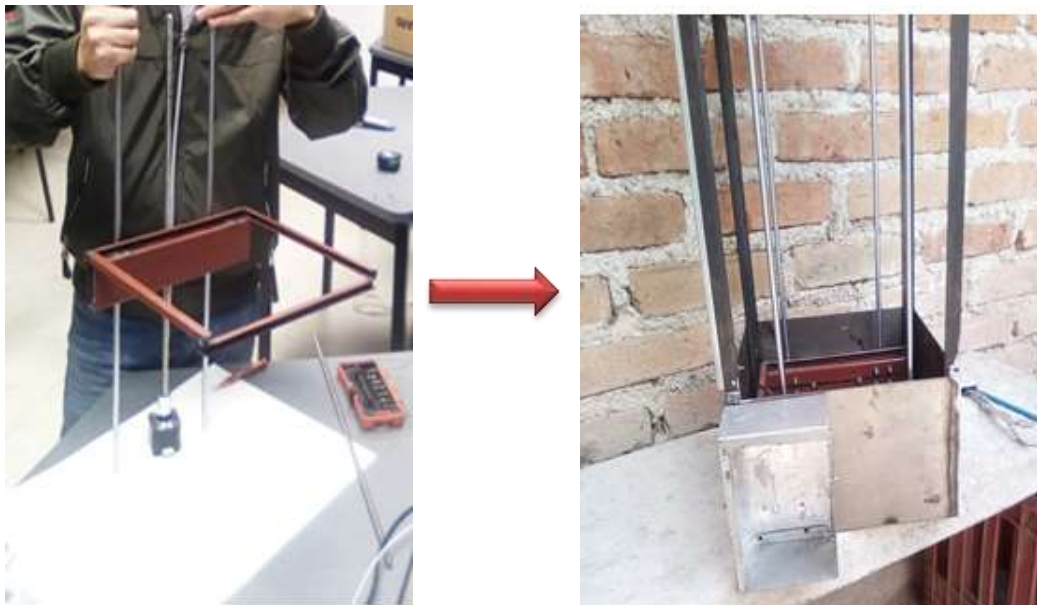
Figura 50. Ensamblado y puesta de la plataforma elevadiza.
