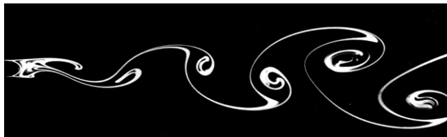
Figura 1.1 Formación de la calle de vórtices en un cilindro circular a Re=140 [7].
