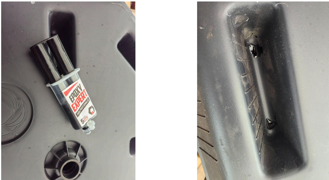
Fig. 17. Pegamento epóxico utilizado para sellar las pequeñas perforaciones existentes desde la etapa de fabricación.
