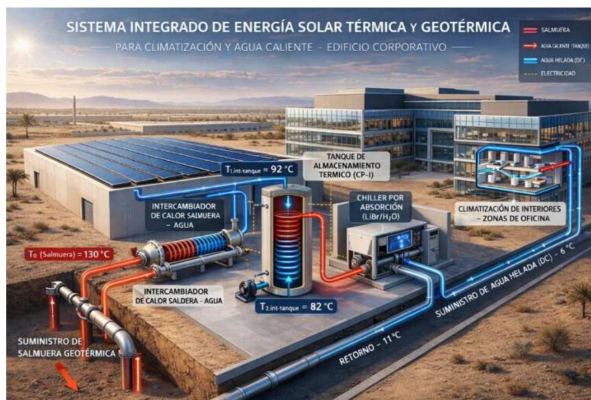
Figura 2.1. Esquema conceptual del sistema solar–geotérmico propuesto para la climatización de edificaciones mediante chiller por absorción.
