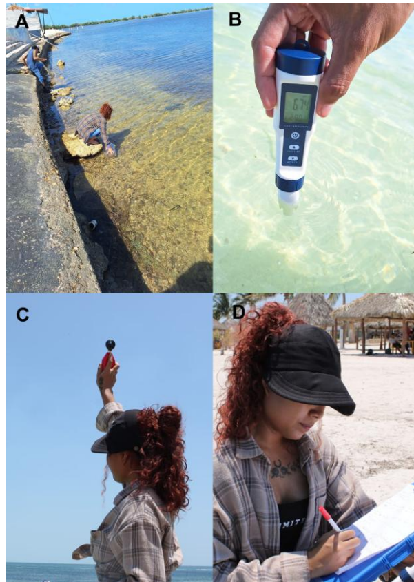
Figura 3. A) Recolección de agua superficial en un bidón de 10L. B) Medición del pH y temperatura del agua con un medidor multiparamétrico. C) Medición de la velocidad del viento y temperatura atmosférica con un anemómetro digital. D) Registro de parámetros ambientales durante el muestreo en playa bonita. Se observa la toma de datos en campo correspondientes a variables físico-químicas y condiciones meteorológicas, realizadas como parte del monitoreo costero para la recolección de muestras destinadas al análisis de microplásticos
