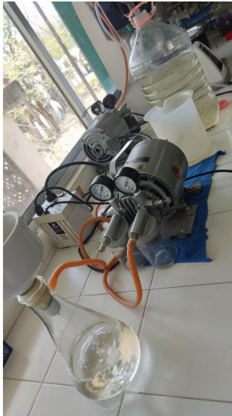
Figura 4. Sistema de filtración por vacío empleado en el laboratorio para la separación de microplásticos presentes en muestras de agua. El equipo consta de una bomba de vacío conectada a un matraz Kitasato con embudo de filtración y mangueras de conexión, permitiendo el paso del líquido a través de un filtro para la retención de partículas sólidas.
