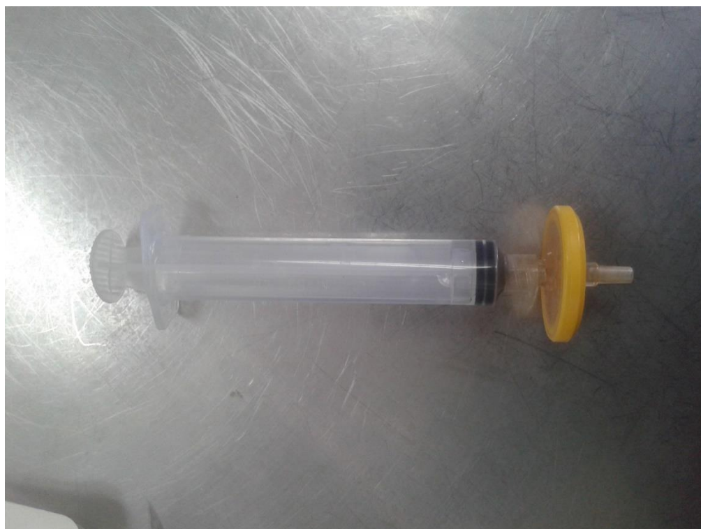
Figura 4.- Dispositivos utilizados en el filtrado de los extractos: jeringa de plástico de 10 mL de capacidad y acrodisco MILLEX GV de 0.22 \mu\text{m} de diámetro de poro.
