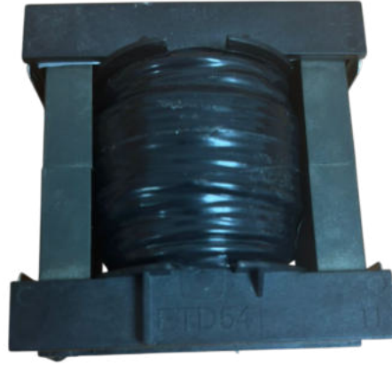
Figura 4.4. Transformador de alta frecuencia construido (núcleo N97, carrete ETD54).
