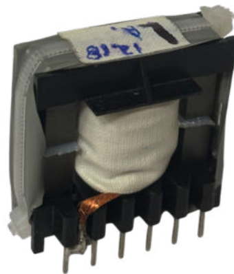
Figura 4.14. Inductor construido sobre núcleo EF25 con material N87.
