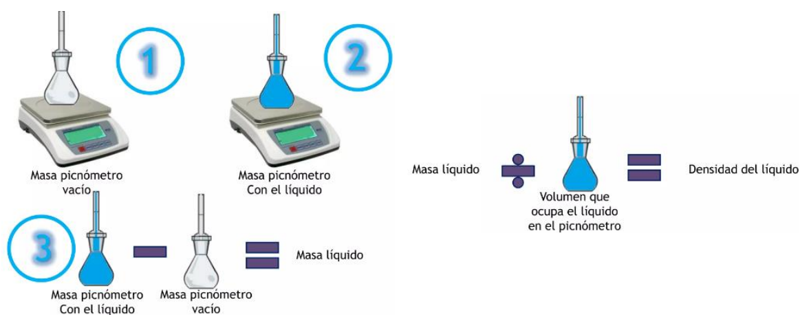
Figura 2.4 Medición de la densidad con picnómetro
