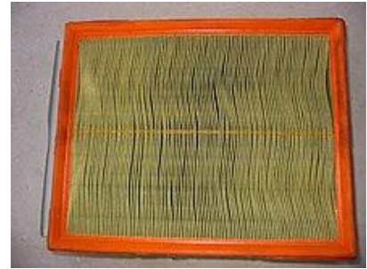
Ilustración 2. Papel filtrante de aire en un motor automático
