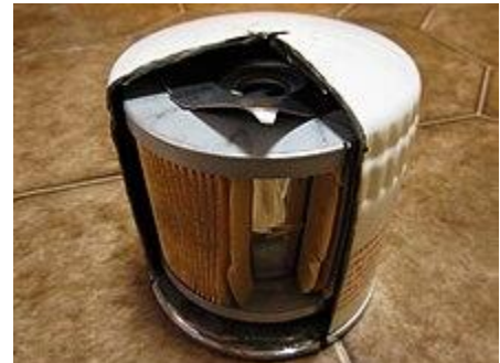
Ilustración 5. Filtro de aceite cortado con papel visible
