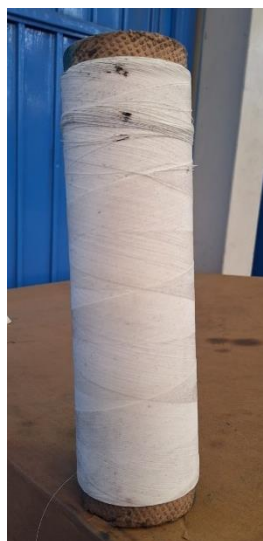
Imagen 4 bobina de WHT-STD manchada
