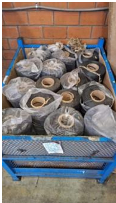
Imagen 9 y 10: canastilla parada por calidad dudosa la etiqueta de la canastilla se especifica el número de bobinas la línea el tipo de bobina y la fecha
