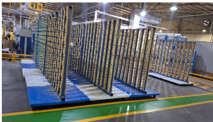
Imagen 2: Carros utilizados para colocar las bobinas metradas que van directo a warpers para hacer un julio de hilo recubierto
