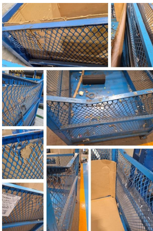
Imagen 16: daños que puede presentar una canastilla
