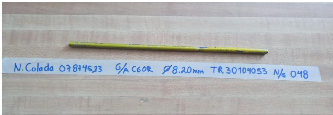
Ilustración 10 Probeta enderezada y cortada de acuerdo con especificaciones de la norma ASTM E8
