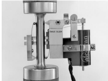
Ilustración 6 Extensómetro tipo LVDT para pruebas de tensión
