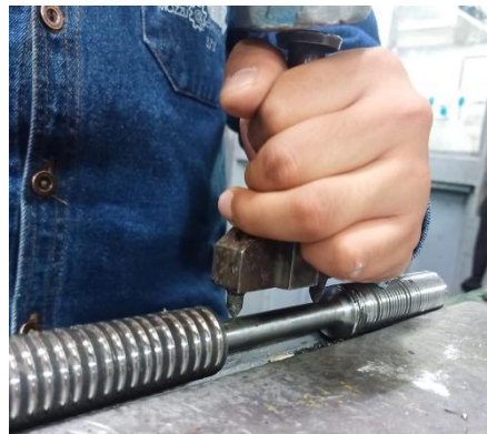
Ilustración 18 Marcación de las probetas para definición del gage length
