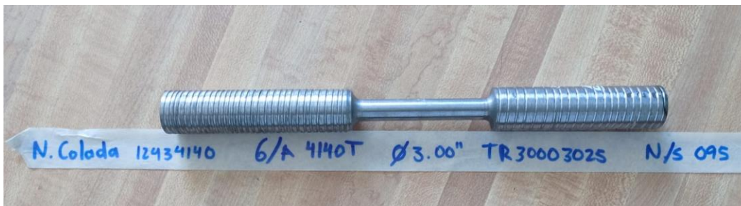
Ilustración 8 Probeta maquinada por el proveedor Maquinados "D FORTI" y que será utilizada para el estudio
