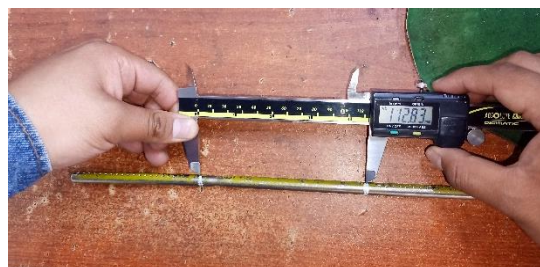
Ilustración 30 Medición de la longitud final que necesita el software para la realización de los cálculos correspondientes
