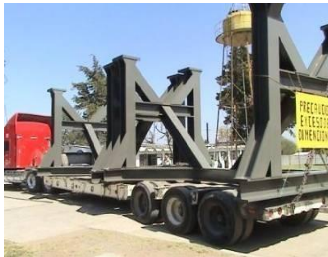
Ilustración 11. Estructuras para soporte de turbinas. Capacidad 80 toneladas, peso 15 toneladas
