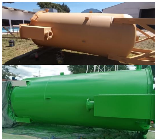
Ilustración 04. Cámara de mezcla para tratamiento de aguas negras
