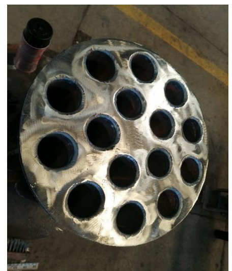
Ilustración 33. Inspección visual de soldadura soporte cartuchos espejo
