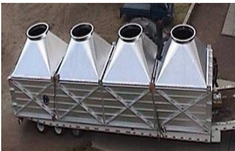
Ilustración 07. Enfriador con peso de 42 toneladas
