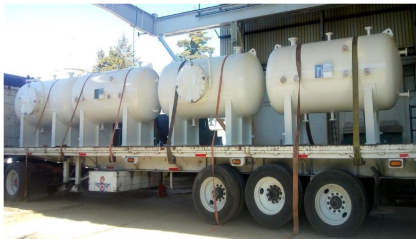
Ilustración 05. Tanque de drenaje
