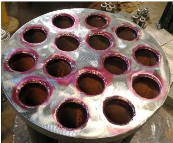
Ilustración 34. Inspección por líquidos penetrantes (penetrador) de soporte cartuchos espejo
