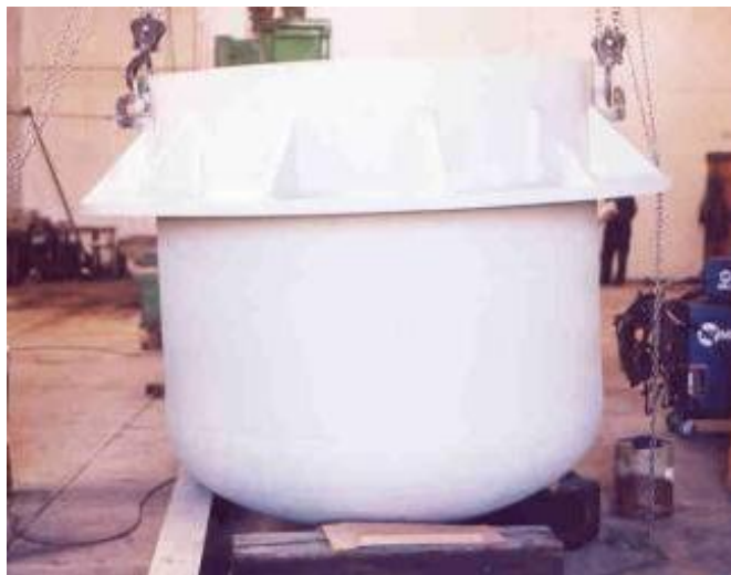
Ilustración 10. Olla para fundición de plomo. Capacidad 5,500 kg
