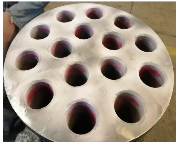
Ilustración 35. Inspección por líquidos penetrantes (revelador) de soporte cartuchos espejo
