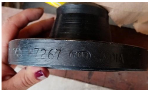
Ilustración 23. Quintado de brida WNRF 2"
