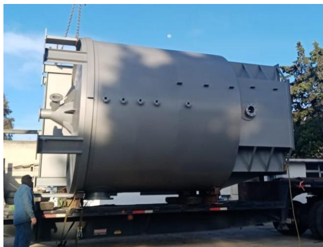
Ilustración 09. Decantador Lamelar, peso 7 toneladas
