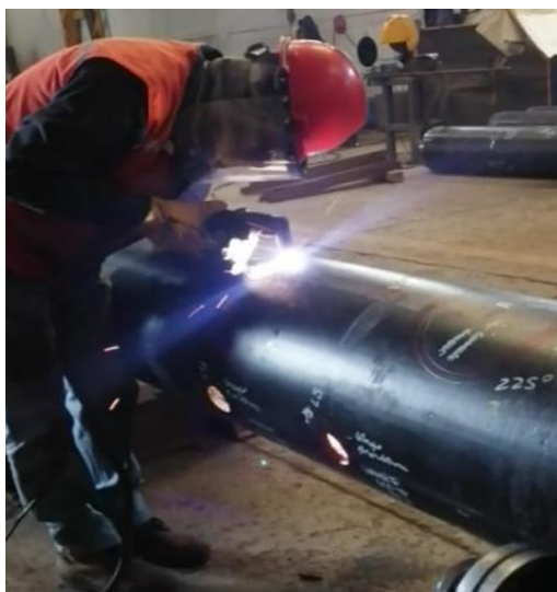
Ilustración 28. Realización de corte con plasma a cuerpo
