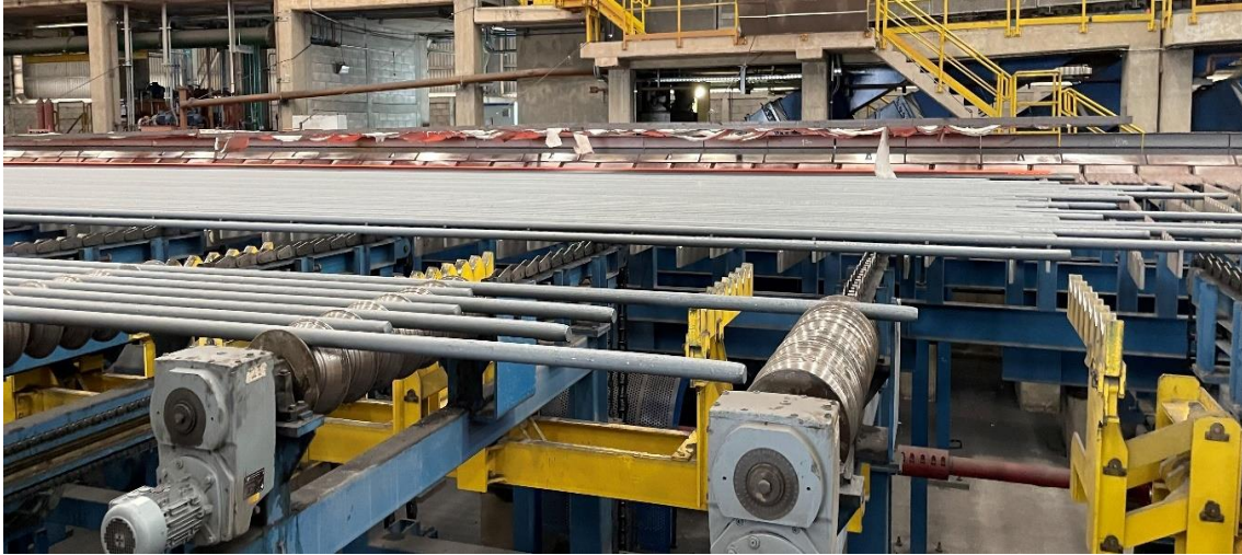
Cama de inspección (imagen 26)
