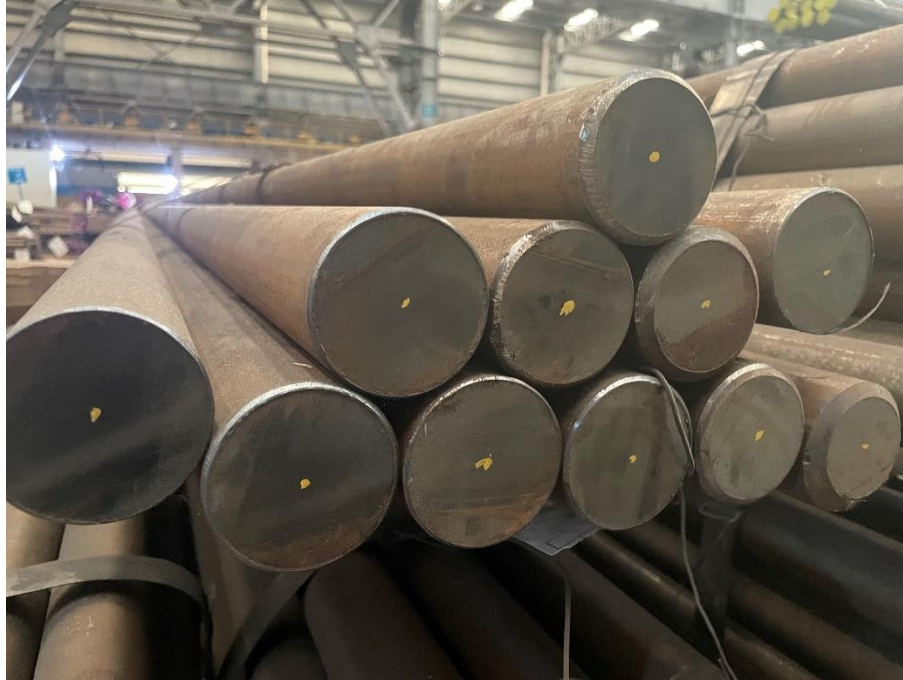
Barras marcadas posterior a prueba RX (imagen 20)
