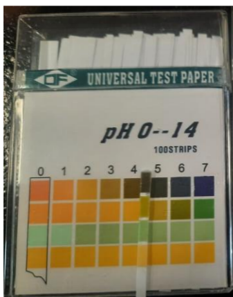
Figura 1 Medición de pH de la solución natural.
