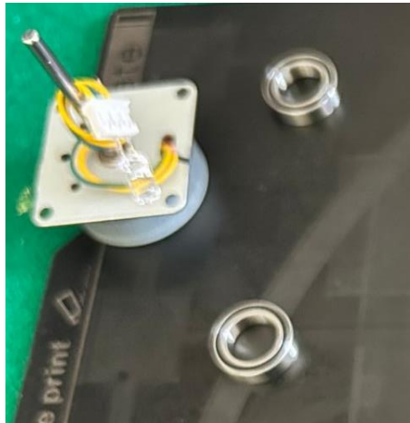
FIGURA 35. GENERADOR Y BALEROS PARA TURBINA (AUDITORIA PROPIA).
