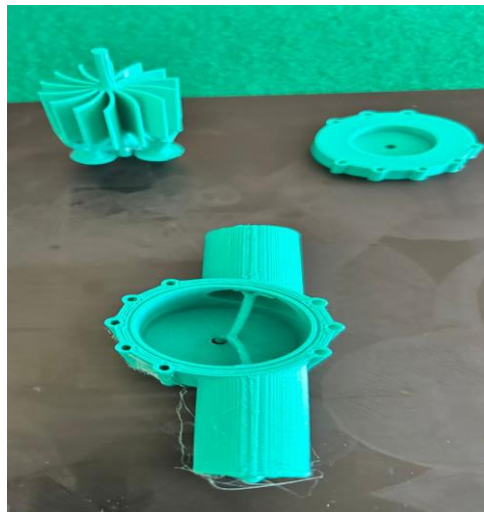
FIGURA 34. COMPONENTES DE TURBINA (AUDITORIA PROPIA).
