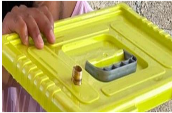
FIGURA 31. PERFORACION PARA CONECTOR (AUDITORIA PROPIA).
