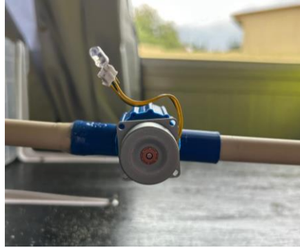
FIGURA 39. TURBINA CON GENERADOR POSICIONADO EN EL PROTOTIPO (AUDITORIA PROPIA).
