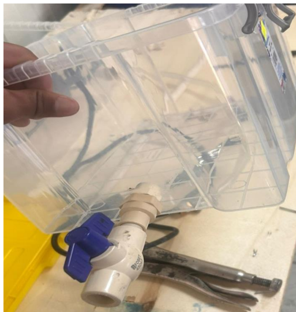
FIGURA 24. COLOCACION DE LLAVE DE PASO (AUDITORIA PROPIA).
