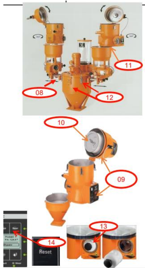
Figura 22. Partes a inspeccionar para de la tolva
