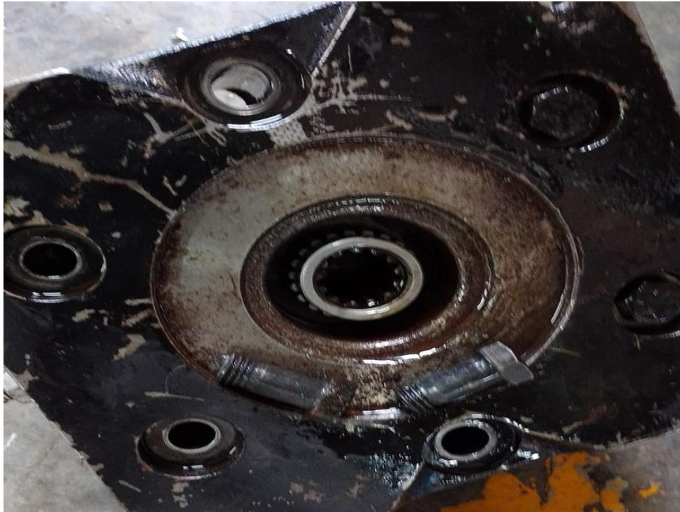
figura 1.2.5 tornillos dañados en un sistema de frenos, el equipo se reportó por fuga de aceite hidráulico.
