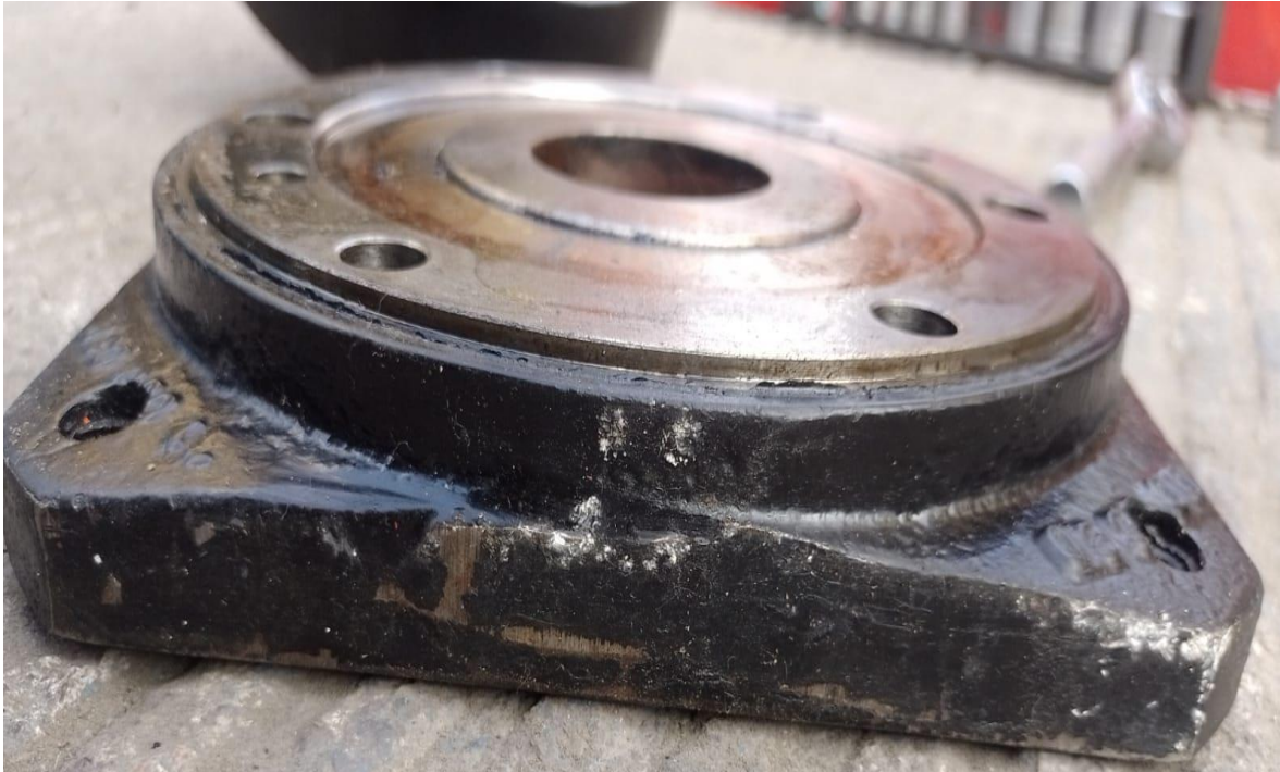
figura 1.1.2 Imagen del embolo interno del sistema de freno
