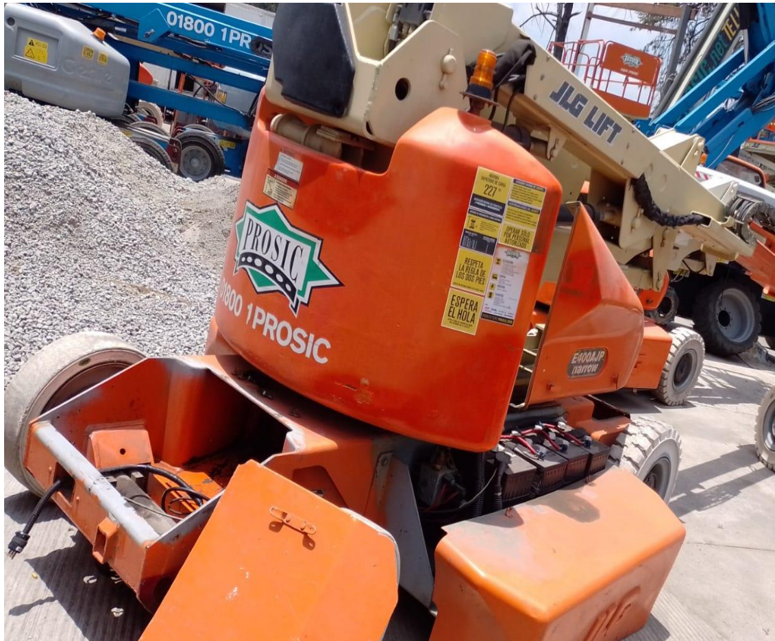
figura 1.2.1 se muestra cuáles son las tapas del equipo que se remueven para acceder a los componentes internos (despiece del equipo).
