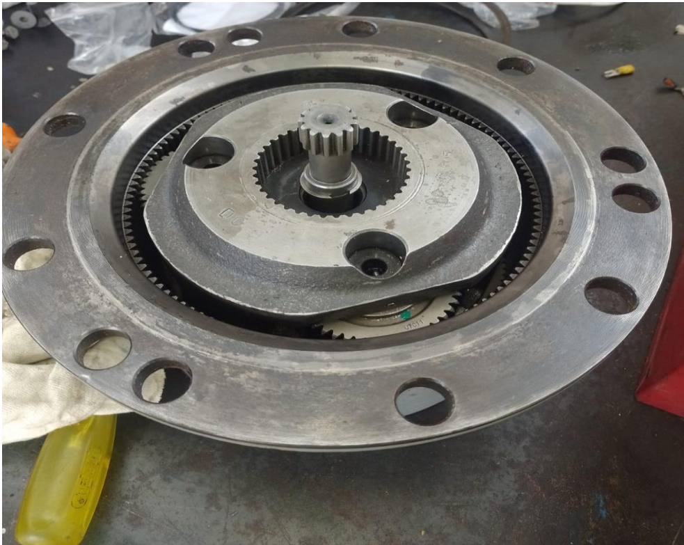
figura 1.0.8 Imagen de un HUB con problema de baja lubricación.
