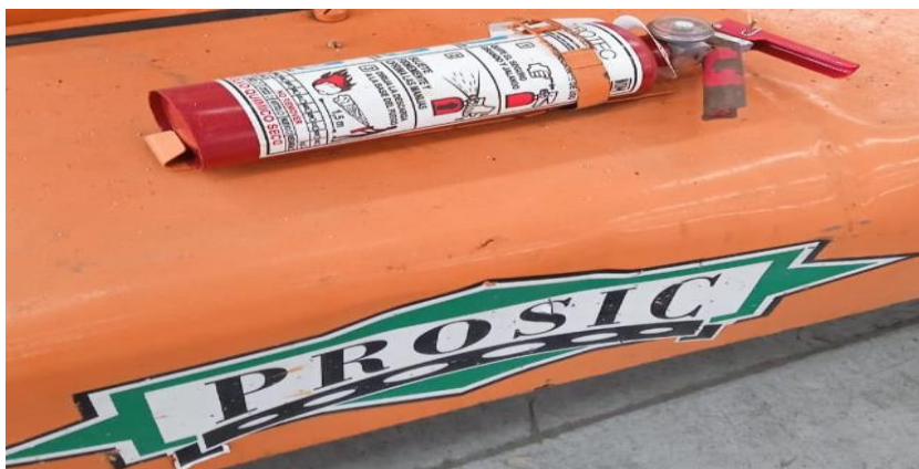
figura 1.1.8 El extintor va en la parte más visible y con mayor acceso
