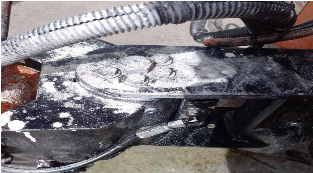
Figura1.1.9 Podemos observar que se existen agentes contaminantes como pintura y concreto en mangueras y motor de giro de la canastilla.
