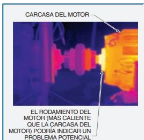
Figura 4 Diferencia de temperatura carcasa – rodamiento, (crédito AMERICAN TECHNICAL PUBLISHERS, INC. ORLAND PARK,)
