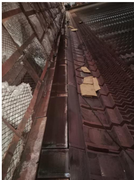
Ilustración 65: Esmerilado de módulos fijos y móviles en cama de enfriamiento Fuente: (Simec Tlaxcala,2023)
