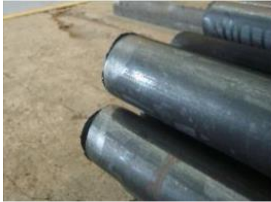
Ilustración 31: Corte con rebaba Fuente: (Simec Tlaxcala,2023)
