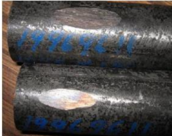
Ilustración 39: Marca camino de rodillo Fuente: (Simec Tlaxcala, 2023)
