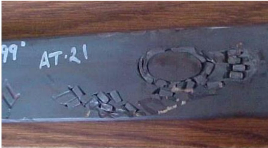
Ilustración 42: Material incrustado Fuente: (Simec Tlaxcala,2023)
