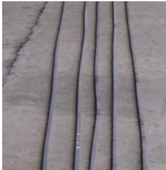
Ilustración 43: Rectitud fuera Fuente: (Simec Tlaxcala,2023)
