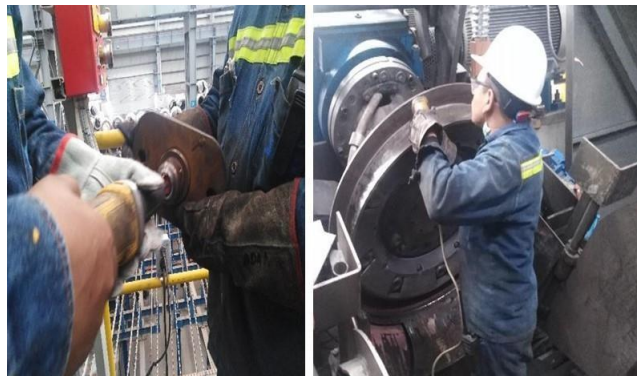
Ilustración 64: Proceso de esmerilar guías y rodillos Fuente: (Simec Tlaxcala,2023)
