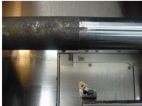
Ilustración 37: Marcas de pase Fuente: (Simec Tlaxcala,2023)
