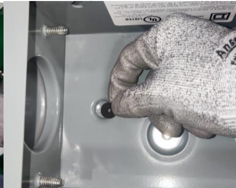
Imagen 18 Colocación de una tapa en la remachadora. Imagen 19. Colocación de un gasket en el gabinete.
