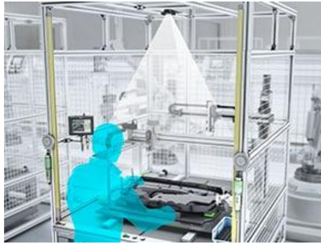
Imagen 16. Concepto de una estación de trabajo en la que se implementó el sistema de visión (cita.
