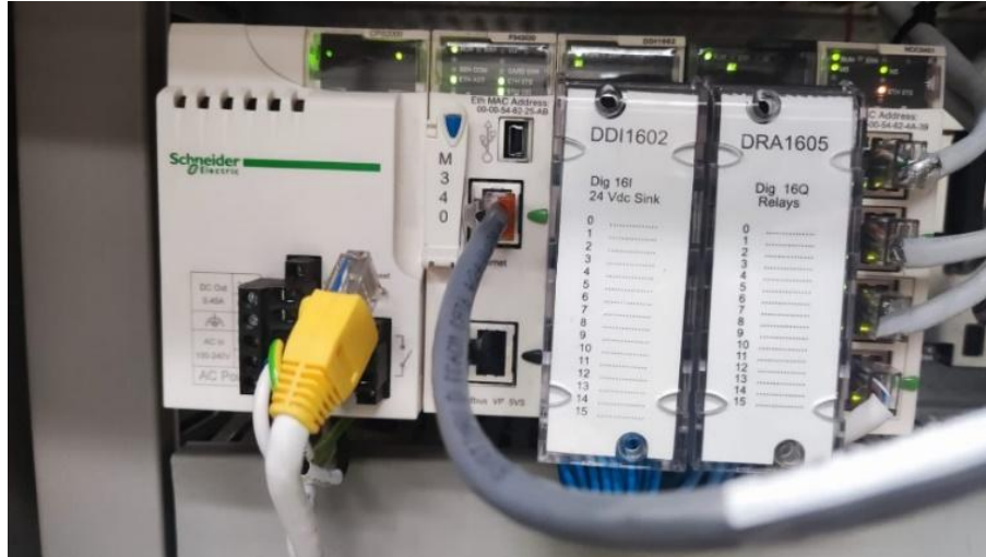
Imagen 33. EL PLC Modicon de Schneider Electric es conocido por su fiabilidad y sencillez.
