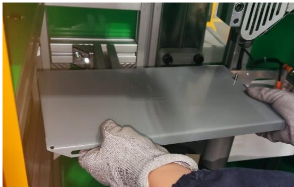
Imagen 18 Colocación de una tapa en la remachadora. Imagen 19. Colocación de un gasket en el gabinete.
