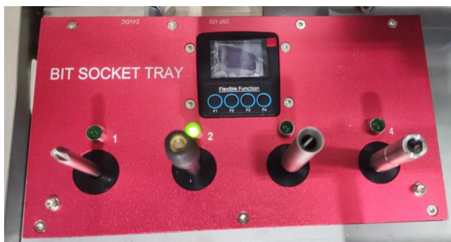
Imagen 58. Puntas de atornillador organizadas en un selector de puntas de la marca Mountz.
