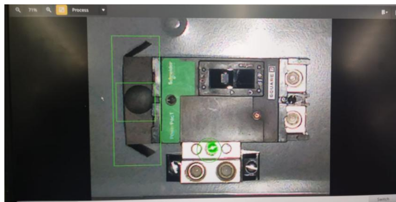
Imagen 42. Captura de una imagen maestra. En esta se encuentran presentes la capucha aisladora y el tornillo del neutro.
