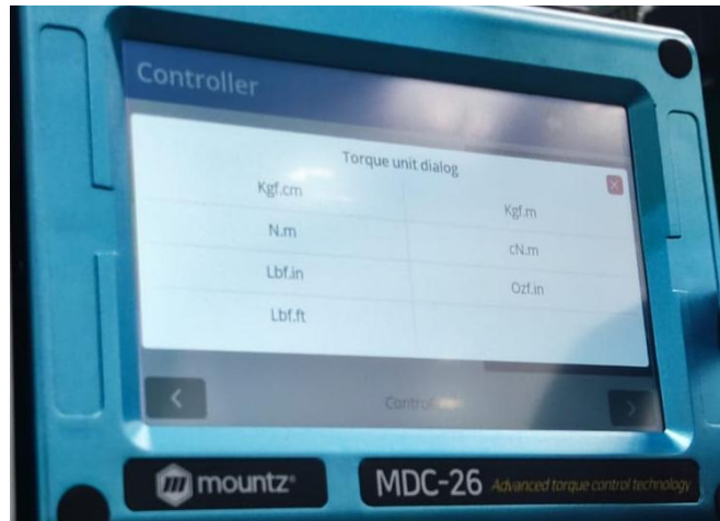
Imagen 57. Programación de un torque en el controlador de Mountz.
