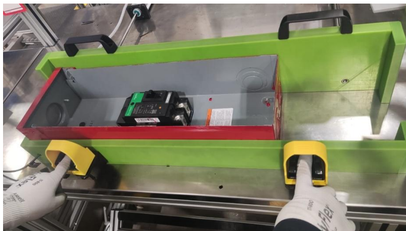
Imagen 36. Sistema de pistones implementado para la sujeción de un gabinete. Funciona para distintos tamaños.
