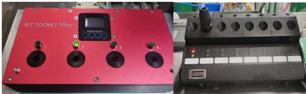
Imagen 27. Selectores de puntas para atornillador de la marca Mountz (izquierda) y Atlas Copco (Derecha)
