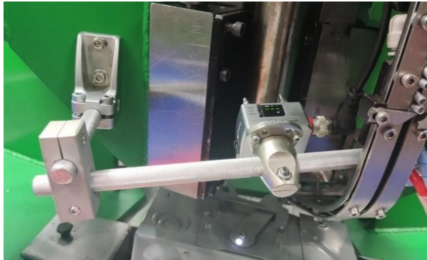
Imagen 22. Implementación de Poka Yoke en una máquina remachadora. Esta valida la presencia del gasket de palanca antes de que la palanca se remache.
