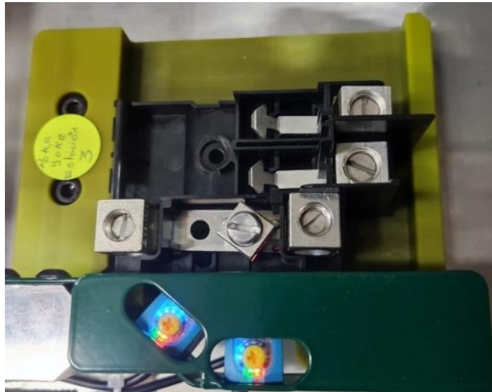
Imagen 54. Aditamento utilizado para el atornillado de zapatas en una base. Los sensores laterales validan la presencia de componentes y desbloquean el atornillado.
