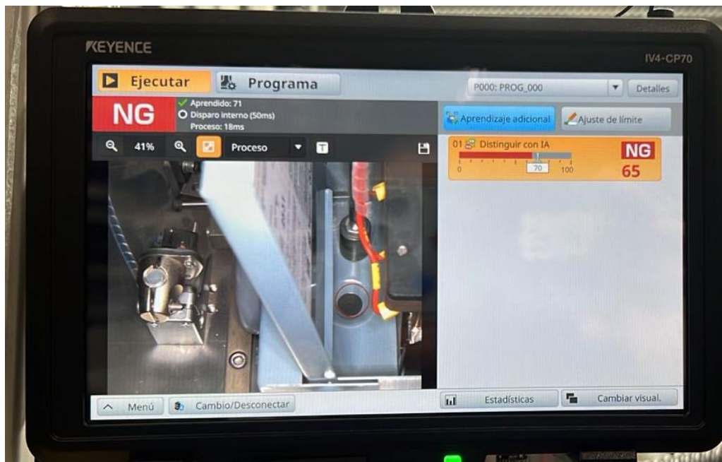
Imagen 59. Sistema de visión con ajuste incorrecto.
