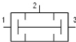
Ilustración 16 Símbolo de válvula de simultaneidad o válvula Y.
