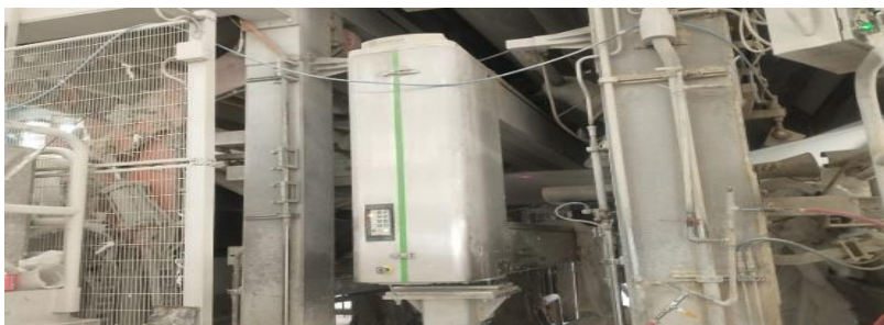
Figura 47 Escáner Valmet para analizar los parámetros establecidos Nota. Fotografía tomada por el autor durante el periodo de Residencia Profesional, febrero de 2025.
