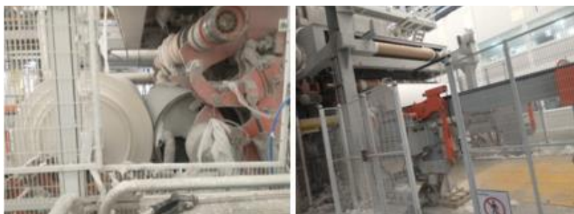
Figura 49 Estaciones del POPE para sacar 3 bobinas de papel Nota. Fotografía tomada por el autor durante el periodo de Residencia Profesional, febrero de 2025.
