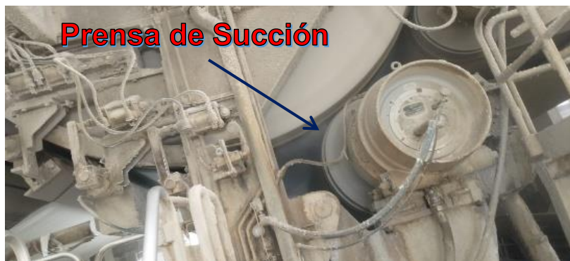
Figura 40 Prensa de Succión para extracción de agua Nota. Fotografía tomada por el autor durante el periodo de Residencia Profesional, febrero de 2025.
