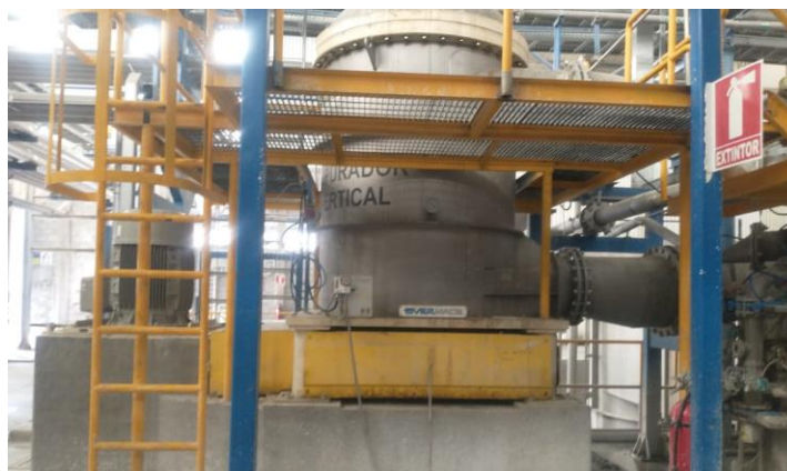
Figura 31 Depurador Vertical principal para el Cribado primario Nota. Fotografía tomada por el autor durante el periodo de Residencia Profesional, febrero de 2025.
