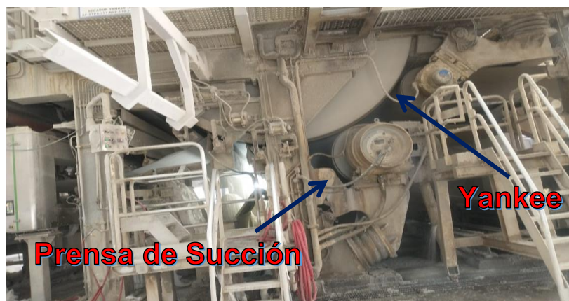
Figura 44 Nip entre la Prensa de Succión y el Yankee
