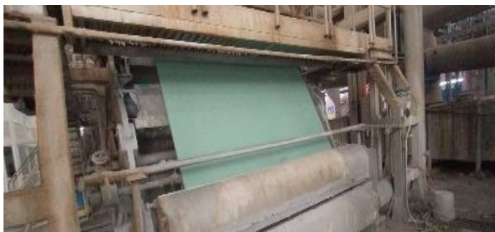
Figura 33 Tela donde se distribuye uniformemente la pulpa Nota. Fotografía tomada por el autor durante el periodo de Residencia Profesional, febrero de 2025.
