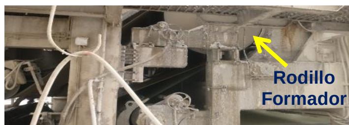
Figura 35 Rodillo formador de la Pulpa en hoja Nota. Fotografía tomada por el autor durante el periodo de Residencia Profesional, febrero de 2025.
