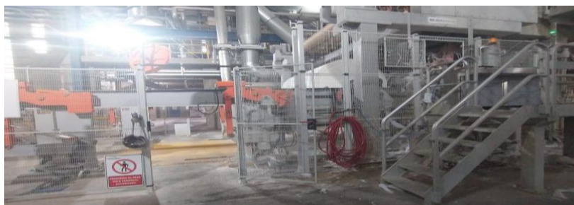
Figura 48 Enrollado de la hoja con el POPE para hacer la bobina de papel Nota. Fotografía tomada por el autor durante el periodo de Residencia Profesional, febrero de 2025.
