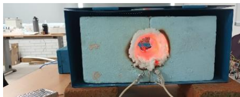
Figura 52. Horno con dimmer.
