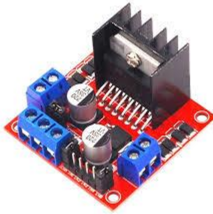
Figura 19. Estructura física del puente H.
