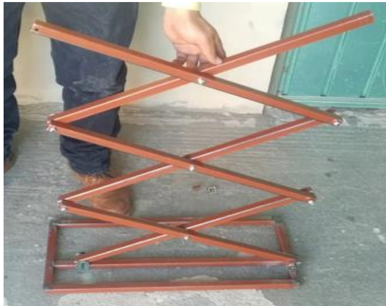
Figura 26. Mecanismo de tijera montado en su base.
