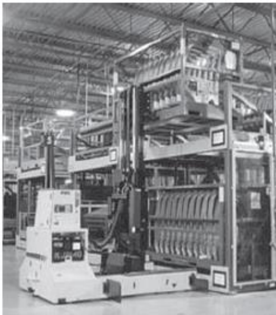
Figura 6b). Un AGV trabajando (recogiendo un bastidor con puertas de automóvil).
