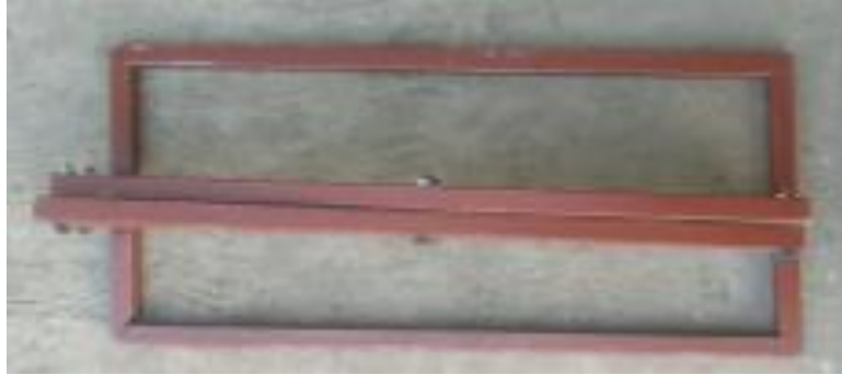
Figura 25. Mecanismo de tijera montado en su respectiva base.
