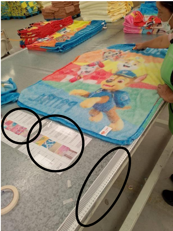
Ilustración 19 Puesta en marcha de la herramienta Poka yoke
