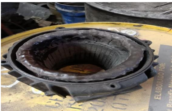
ILUSTRACIÓN 31 MOTOR NUEVO SIN RECUBRIMIENTO DE EMBOBINADO
