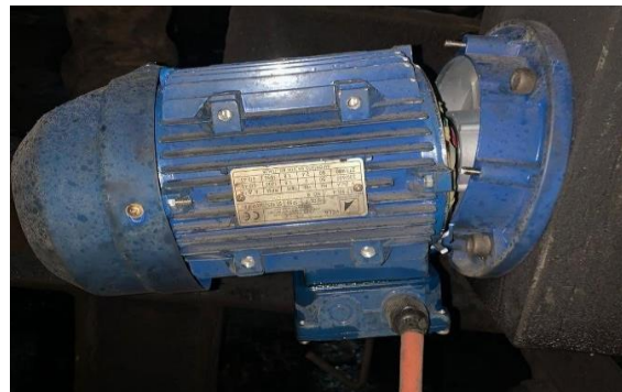
ILUSTRACIÓN 26 MOTOR QUEBRADO DE LA TAPA DE FIJACIÓN
