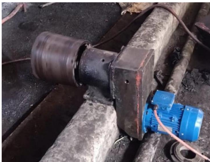
ILUSTRACIÓN 38 PRUEBA DE MOTOR Y REDUCTOR
