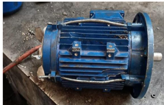
ILUSTRACIÓN 30 MOTOR QUEBRADO CON ESPÁRRAGOS AÑADIDOS
