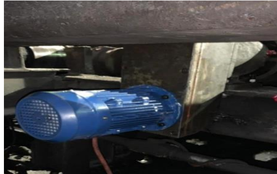
ILUSTRACIÓN 28 MOTOR MONTADO EN REDUCTOR
