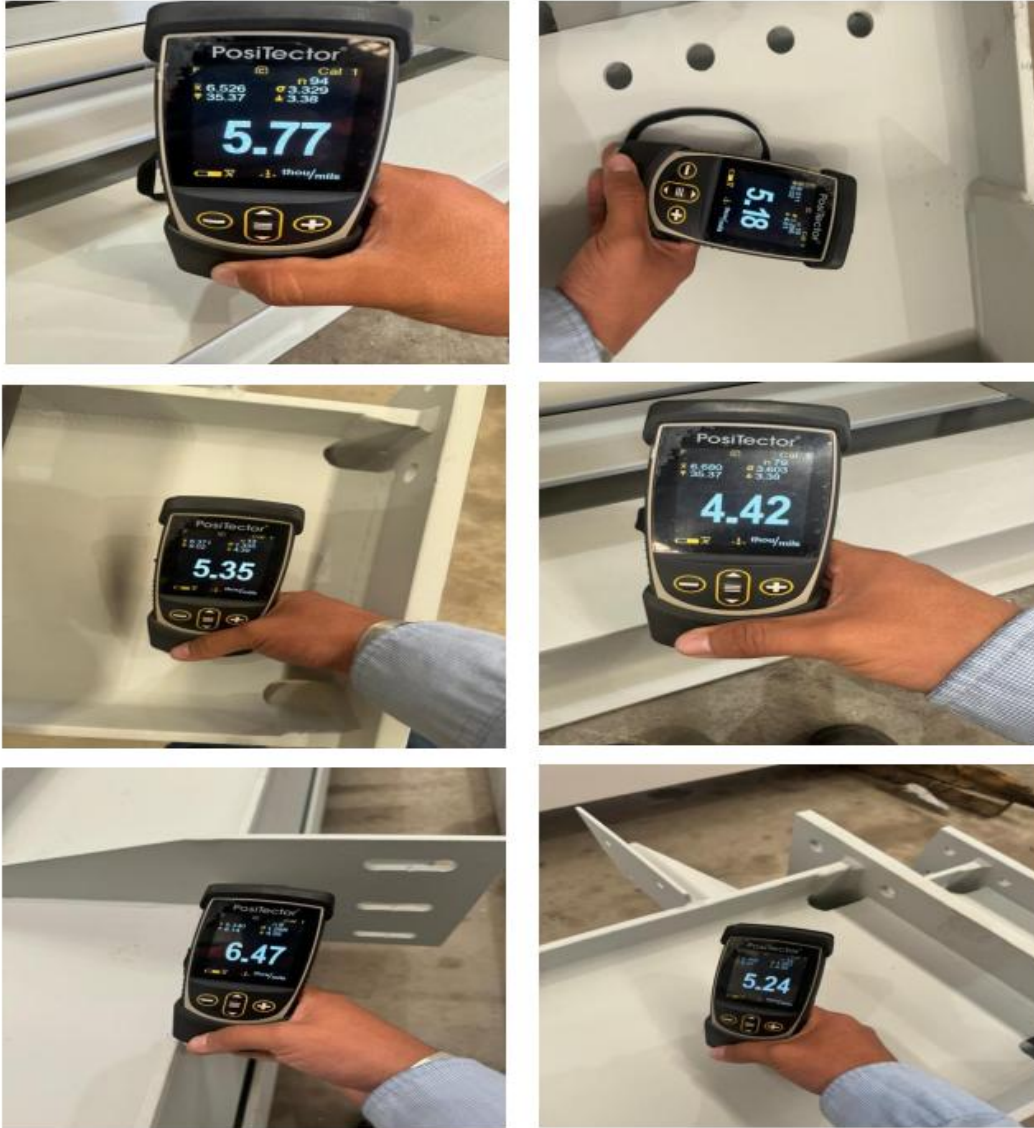
MEDICION DE ESPESORES DE PINTURA
