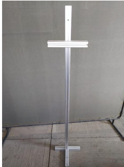
Figura 23.-Base del gabinete [Fuente: Propia, 2021]
