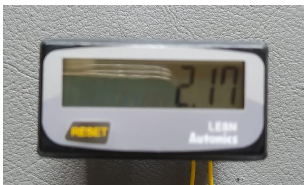
Figura 16.-Horometro mostrando tiempo almacenado [Fuente: Propia, 2021]
