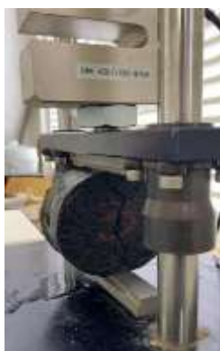
Imagen 4.9. Especímenes llegando a la falla.
