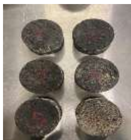
Imagen 4.5. Especímenes recibidos en planta y cálculo de propiedades volumétricas
