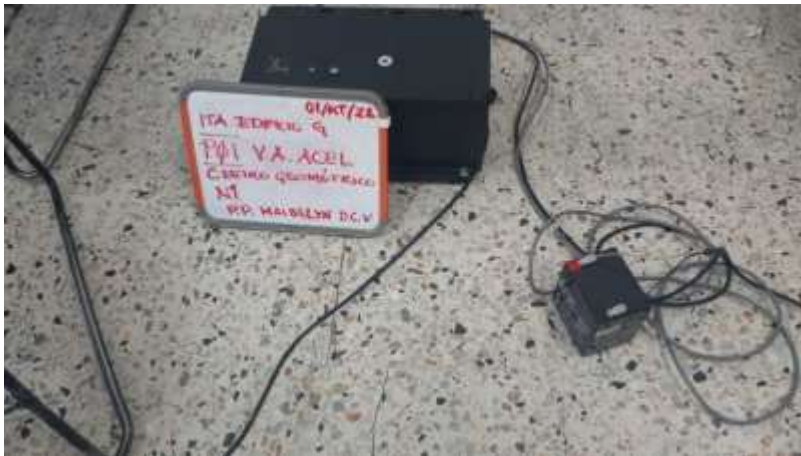
Imagen 6. Modo de Vibrar, Edificio G, Punto 01, Centro Geométrico N1.
