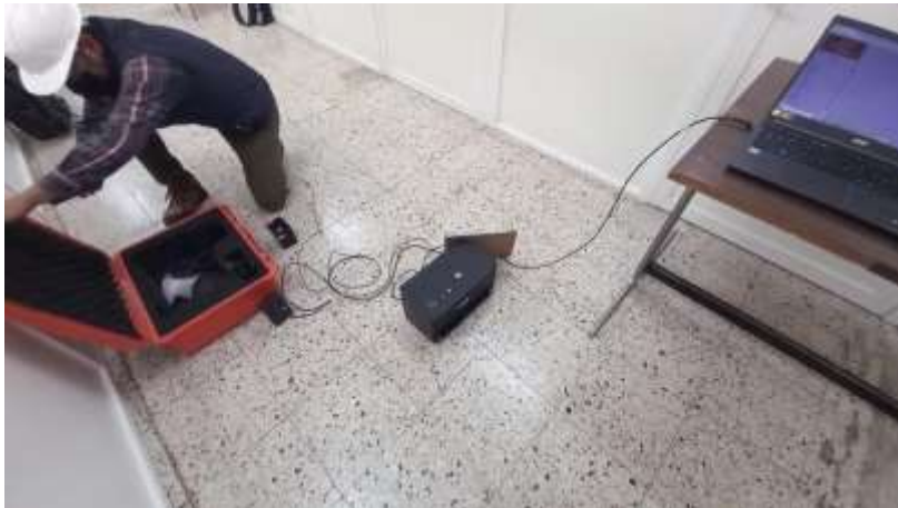
Imagen 58. Modo De Vibrar, Edificio G Punto 03, centro geométrico PB
