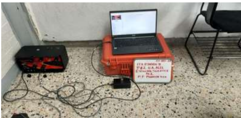
Imagen 4. Modo de Vibrar, Edificio B, Punto 02, Esquina Sur-Este N1.
