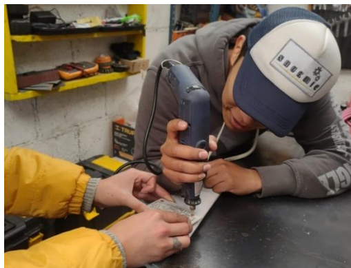
Imagen 48 Perforación de la tarjeta con un taladro
