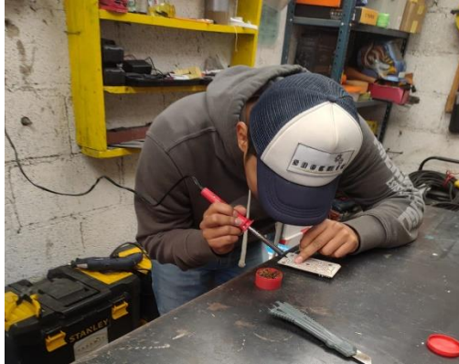
Imagen 50 Proceso de soldadura de los componentes
