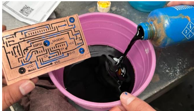
Imagen 45 Colocando la placa en el ácido férrico y
