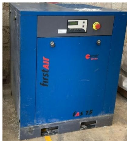
Figura 6 Compresor de tornillo de la empresa ECOCHEM.
