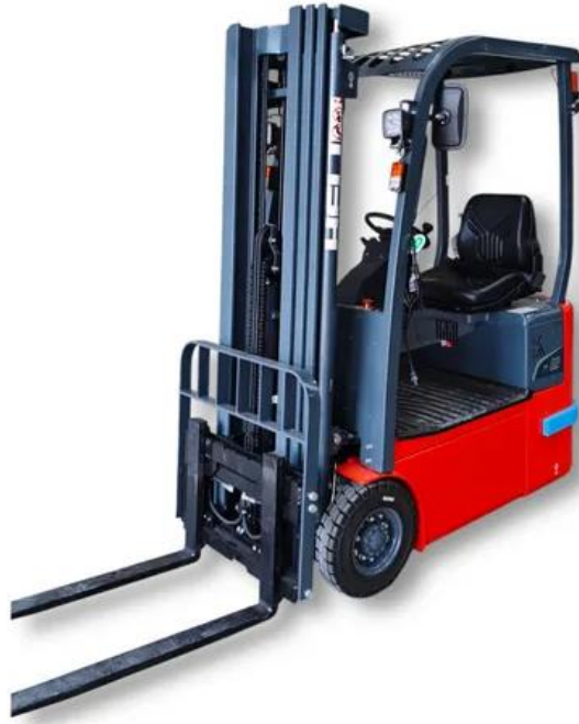
Figura 16 Montacargas marca Heli de 1.2t a 4.5m
