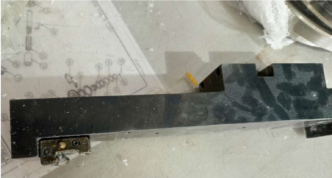
Ilustración 48 rodamiento lineal sujeto a la base del porta cuchillas
