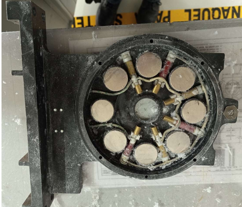
Ilustración 9 motor de Yunque desmontado, se encuentra en espera de mantenimiento
