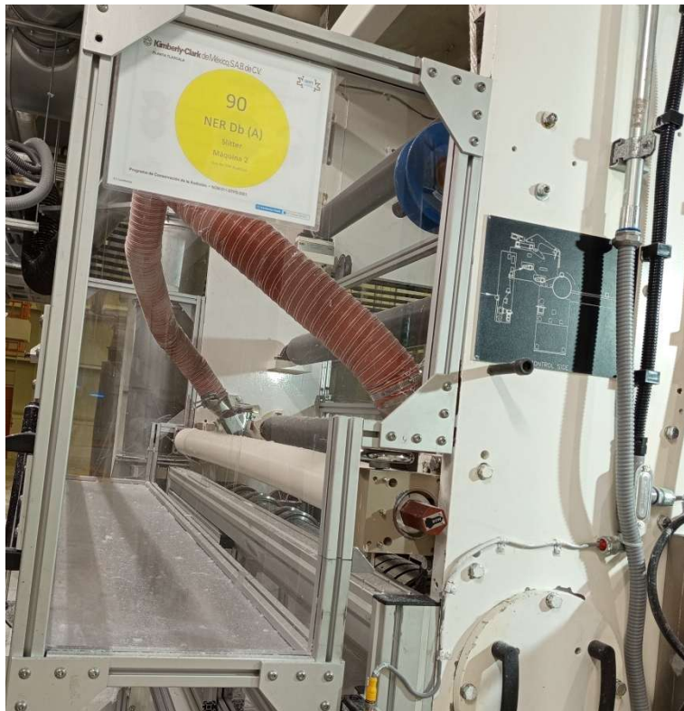
Ilustración 26 la imagen muestra dos conductos de vacío que recolectan el recorte
