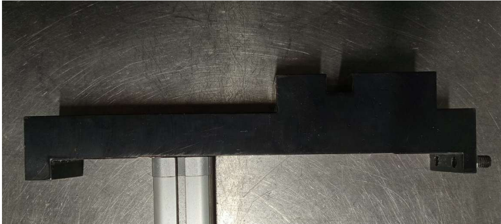
Ilustración 56 la imagen muestra la zona en la que se posiciona el cilindro y la base del porta cuchillas
