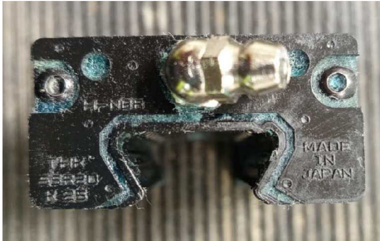
Ilustración 22 rodamiento lineal del porta slitters
