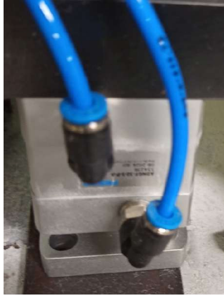
Ilustración 57 cilindro con conexiones tipo y líneas de aire
