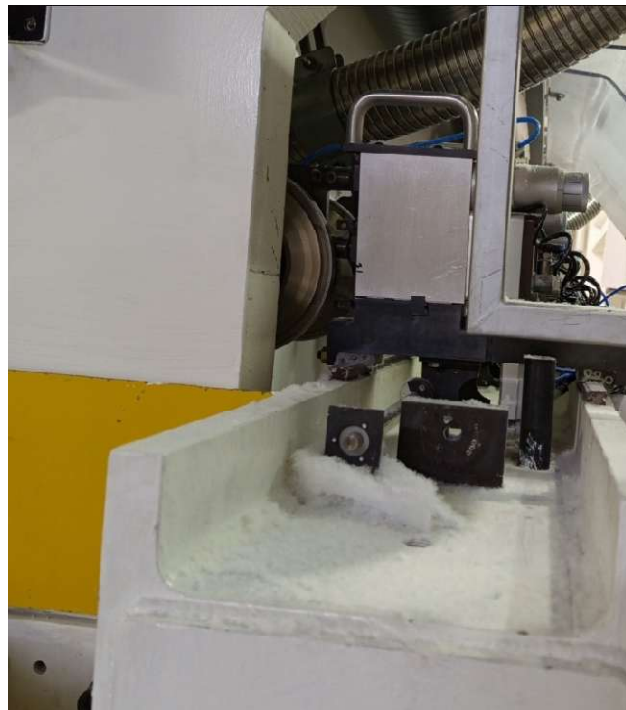
Ilustración 3 Acumulación de fibras y partículas en el área del porta cuchillas, que provoca atascamientos mecánicos durante la operación del slitter.
