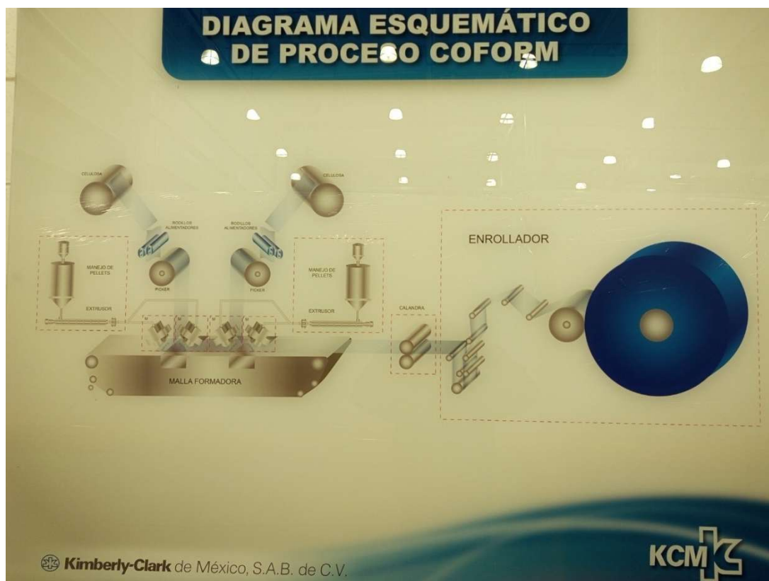
Ilustración 1 diagrama esquemático del proceso de coform
