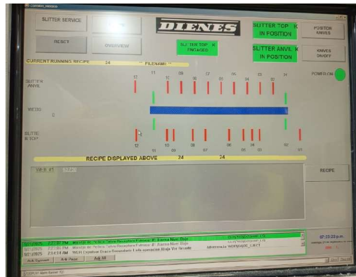
Ilustración 5 menú en la estación de control para modificar la posición de slitter y yunque de manera automática
