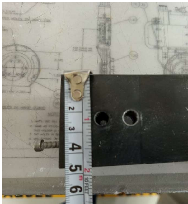
Ilustración 54 toma de medidas del ancho de la base del porta cuchillas
