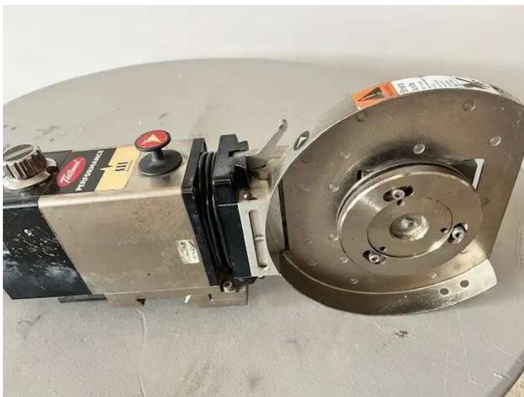
Ilustración 20 porta cuchillas de la serie Tidland Performance
