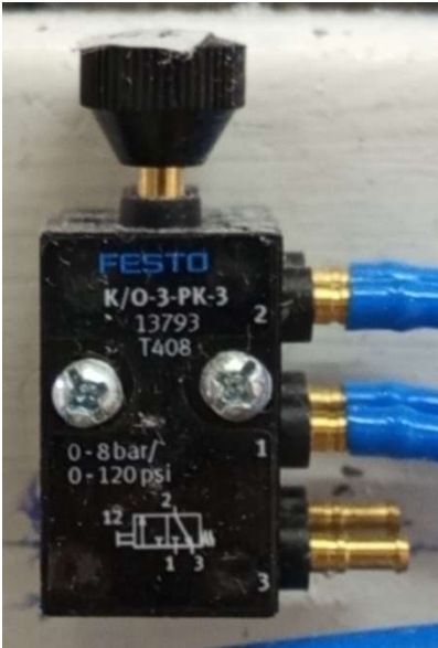
Ilustración 59 válvula K/O-3-PK-3 que se usa como control de la válvula direccional
