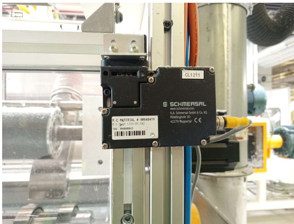
Ilustración 28 dispositivo schmersal sobre una guarda
