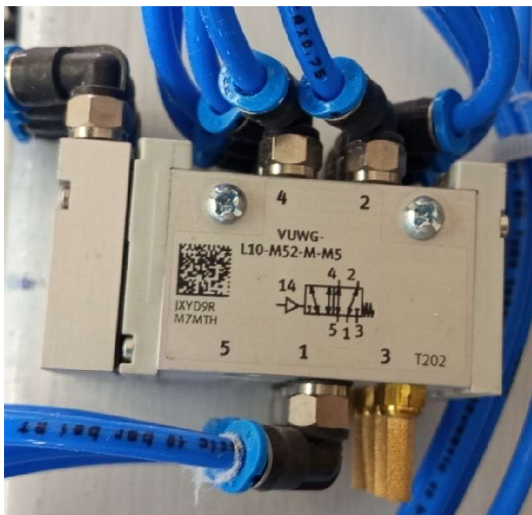
Ilustración 58 válvula VUWG-L10-M52-M-M5 con sus 4 conexiones
