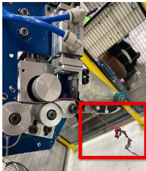
Figura 3.10 Ejemplo de tensión irregular en cinta
