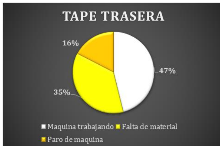
Figura 3.11 Grafica tipo pastel con porcentajes de (Maquina trabajando, Falta de material, Paro de maquina).
