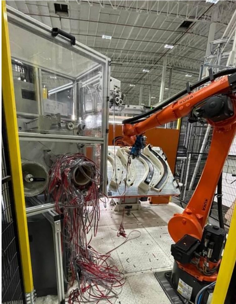
Figura 3.5 Identificación de caídas excesivas de cinta responsables de los enredos.
