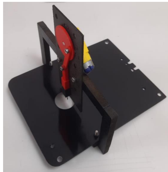
Figura 60: Mecanismo biela – manivela con base de lado
