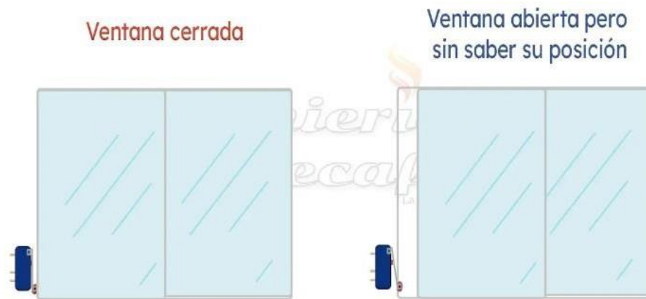
Figura 1.4.1.1. Ejemplo del funcionamiento de un interruptor de carrera
