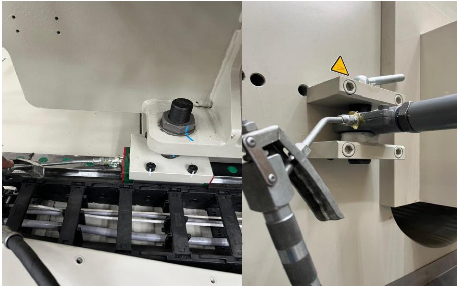
Imagen 13. lubricación a partes móviles de UI de maquina 48, Eugen Wexler, 2025
