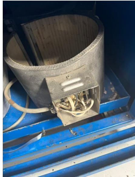
Imagen 11. Resistencia en buen estado, Eugen Wexler, 2025
