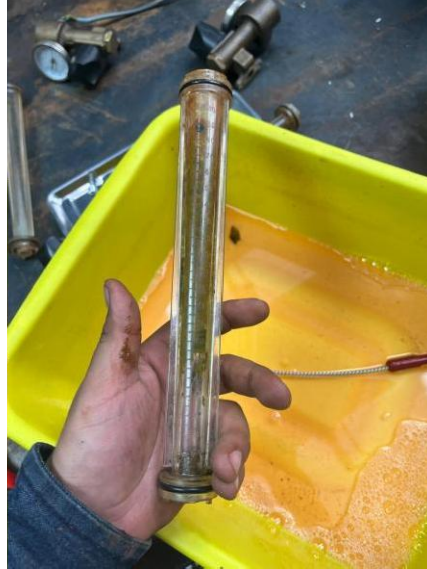
Imagen 27. Flujómetro desarmado de maquina 41, Eugen Wexler, 2025
