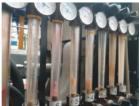
Imagen 25. Flujómetros o rotámetros maquina 41, Eugen Wexler,2025
