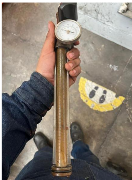
Imagen 26. Flujómetro sucio maquina 41, Eugen Wexler, 2025
