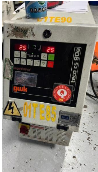
Imagen 38. Termorregulador de agua funcionando de maquina 42, Eugen Wexler, 2025.
