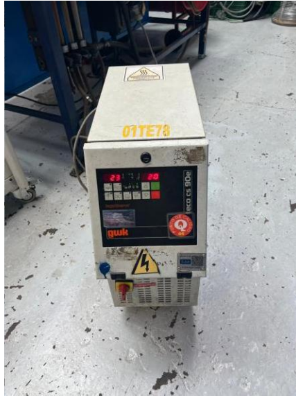
Imagen 29. Termo regulador de agua GWK de maquina 43, Eugen Wexler, 2025
