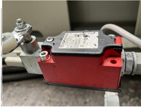
Imagen 22. Micro de seguridad sucio, maquina. 47, Eugen Wexler, 2025.
