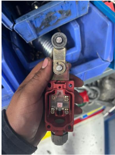
Imagen 24. Micro de seguridad dañado maquina 44, Eugen Wexler, 2025.
