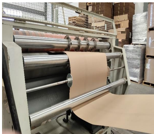
Fig. 17 Proceso de corte papel Kraft
