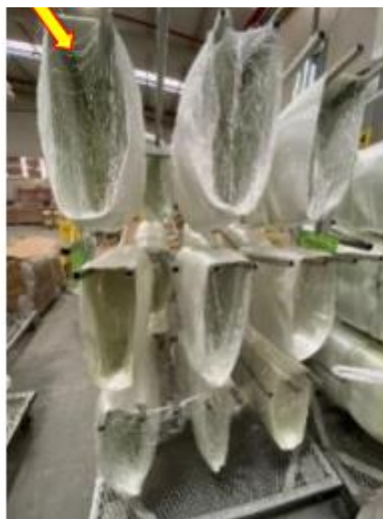
Ilustración 28 Manera en que se deben de colocar los rollos dañados.
