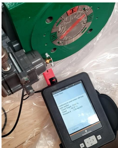
Figura 78. Apertura y cierre de válvula
