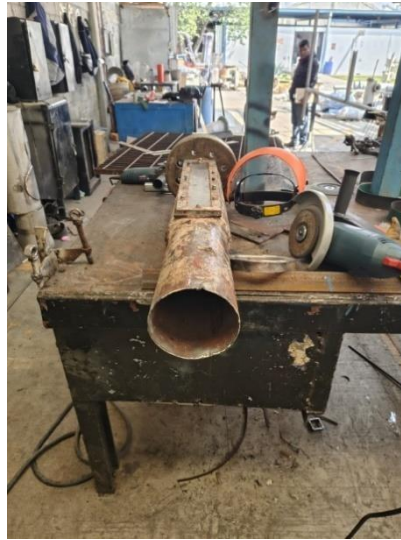
Ilustración 3-24 Corte de cono con pulidora Fuente: Elaboración propia
