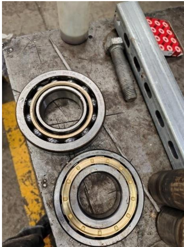
Ilustración 3-42 Cambio de rodamientos Fuente: Elaboración propia
