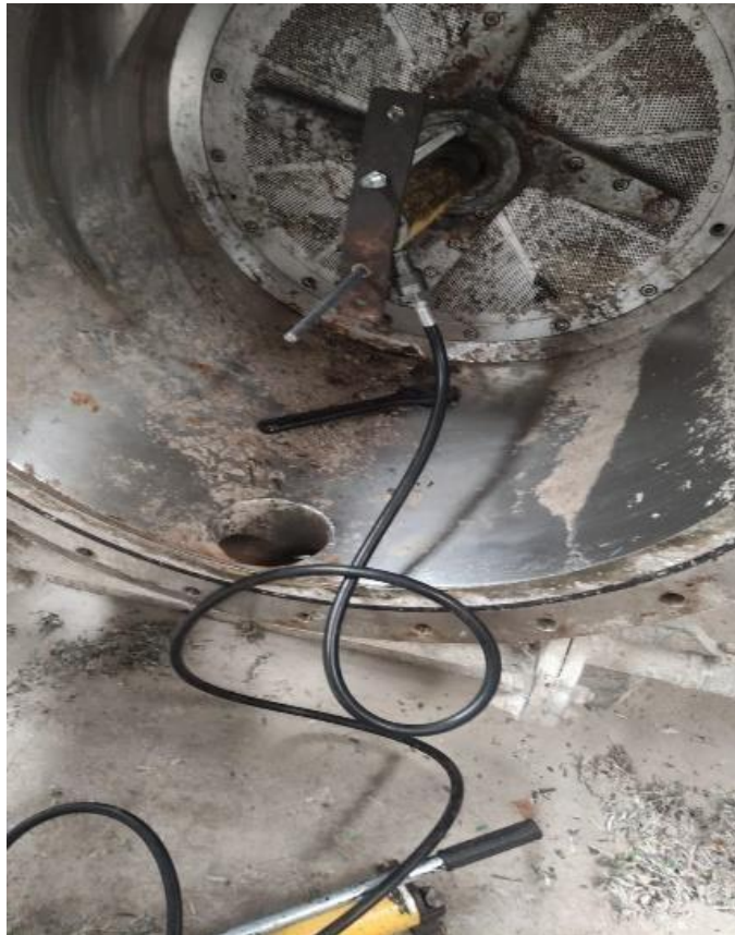
Ilustración 3-5 Desmontaje de impulsor de Multinet Fuente: Elaboración propia
