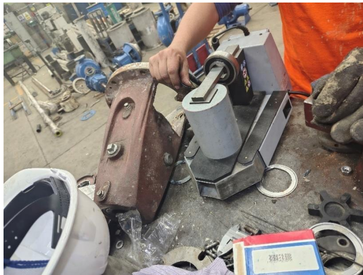
Ilustración 3-52 Calentamiento de rodamientos Fuente: Elaboración propia
