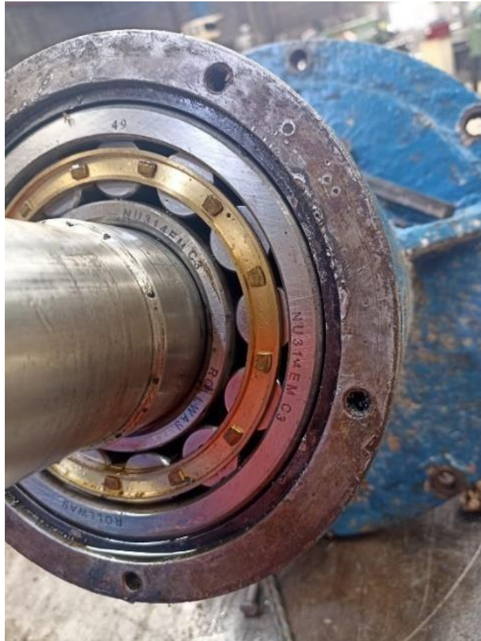
Ilustración 3-20 Cambio y engrasado de rodamientos
