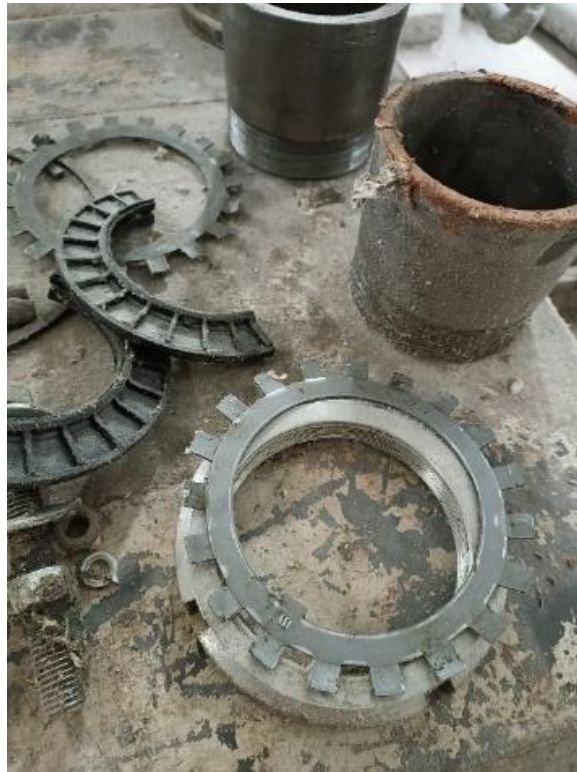
Ilustración 3-10 Manguito de fijación aro de fijación y tuerca de fijación extraídos Fuente: Elaboración propia
