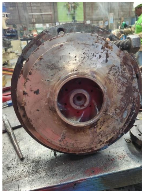
Ilustración 3-39 Extracción de impulsores Fuente: Elaboración propia
