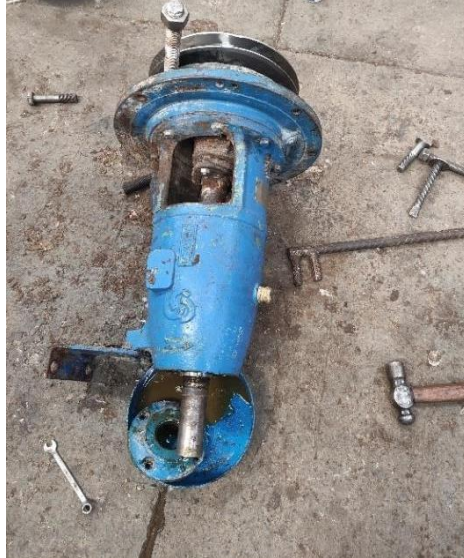
Ilustración 3-38 Desarmado de bombas Fuente: Elaboración propia
