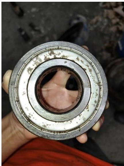
Ilustración 3-41 Óxido y corrosión en rodamientos extraídos Fuente: Elaboración propia
