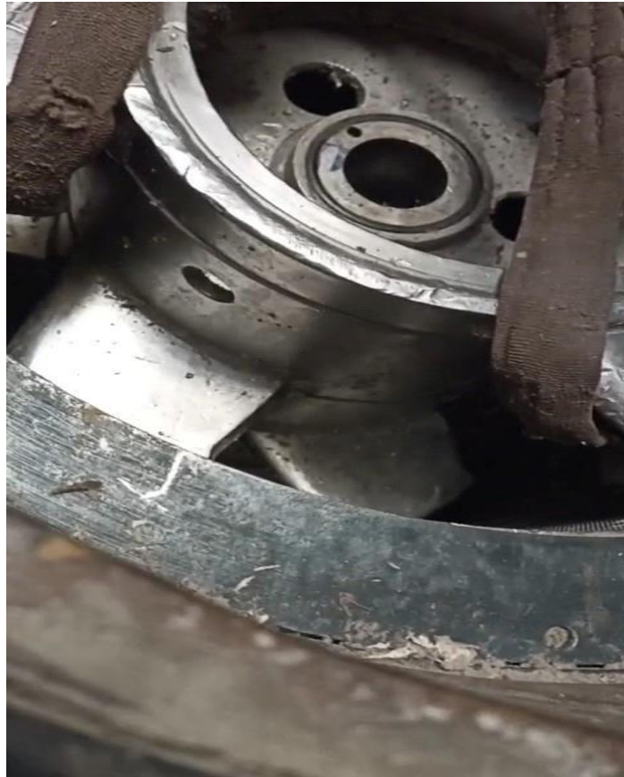
Ilustración 3-19 Desmontaje de rotor de Kriba Fuente: Elaboración propia
