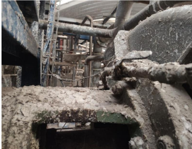
Ilustración 4-7 Cajon de rodamientos con polvo Tailnet Fuente: Elaboración propia del equipo
